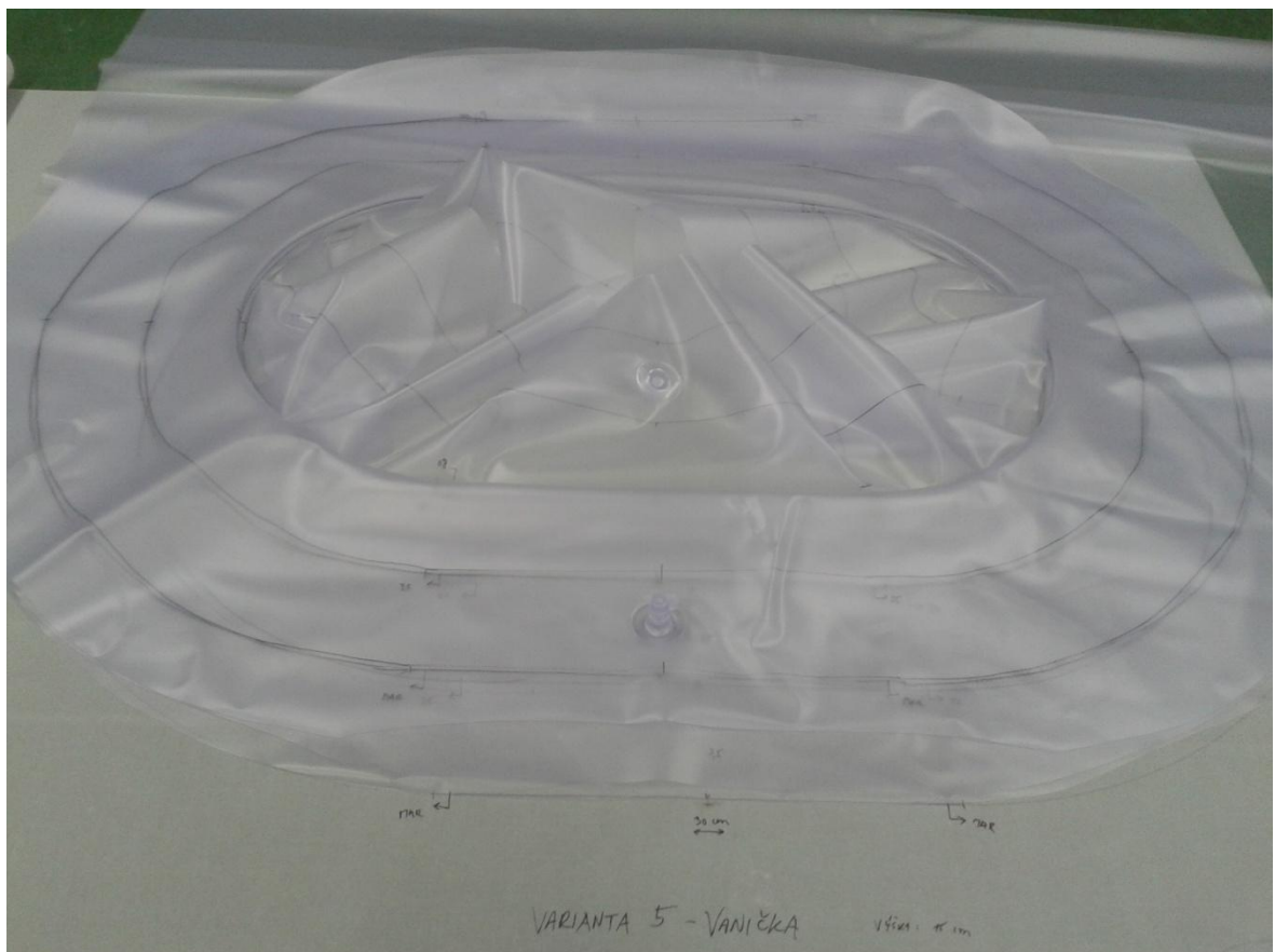
Obr. 33. Svařování vnitřních stěn
