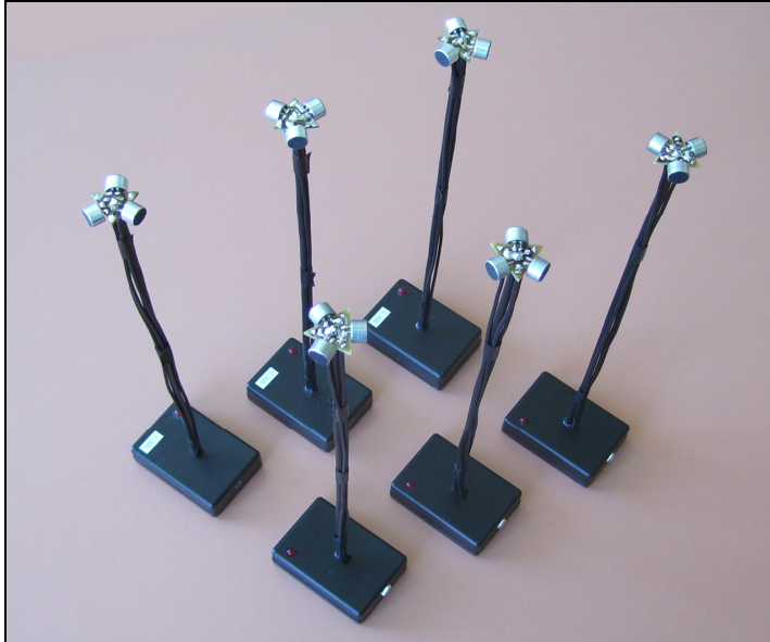
Obr. 23. Vnější provedení mikrofonních jednotek.
