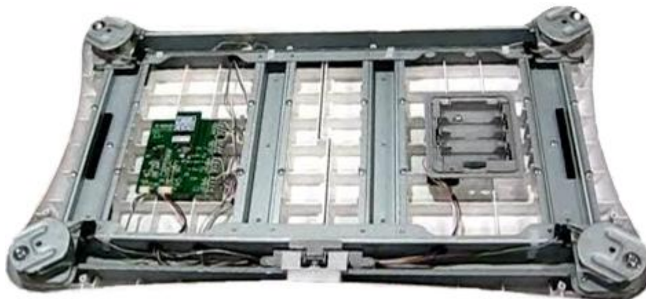
Obr. 5.1: Wii Balance Board bez spodního krytu
