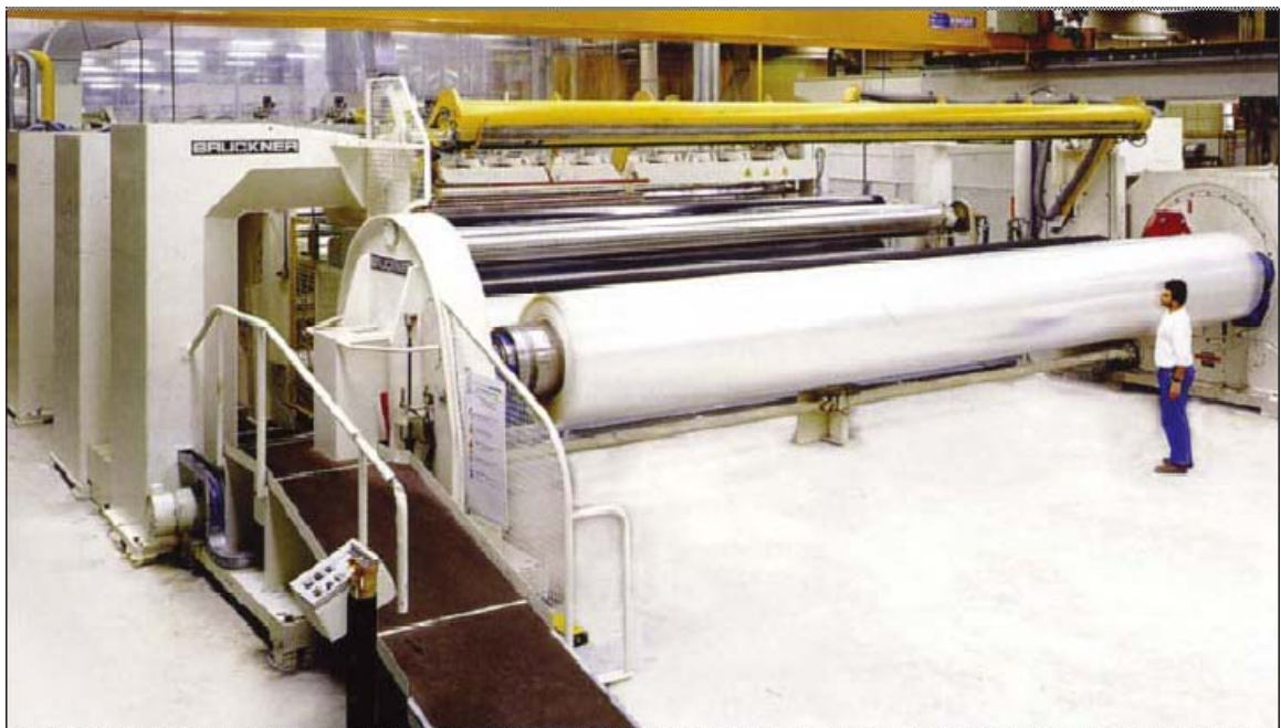
Obr. 11. Zařízení k výrobě biaxiálně orientovaného polypropylenu
