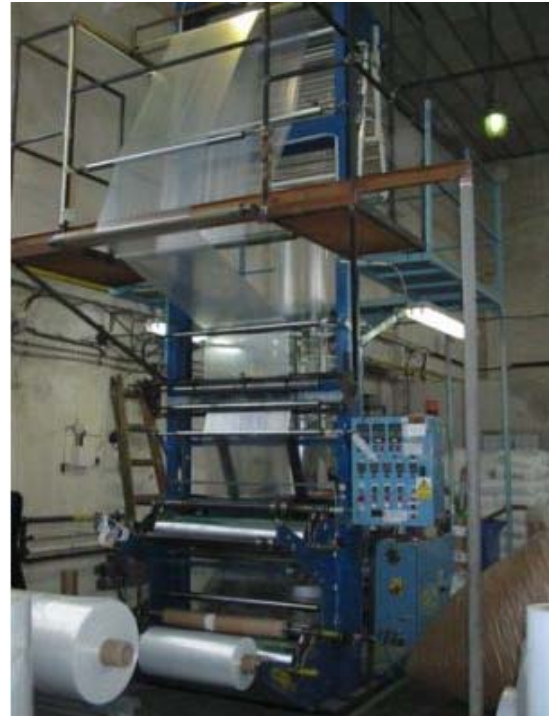
Obr. 13 Extruder s horním odtahem – pohled ze strany od šnekového vytlačovacího stroje a od navíjecího zařízení
