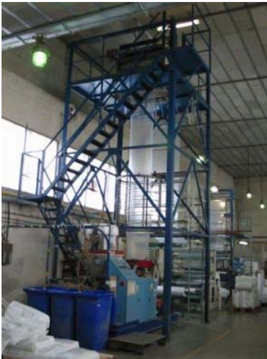
Obr. 13 Extruder s horním odtahem – pohled ze strany od šnekového vytlačovacího stroje a od navíjecího zařízení
