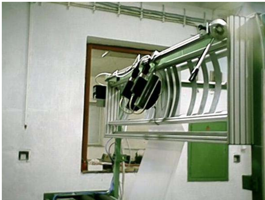
Obr. 24. Podélné svařování fólií
