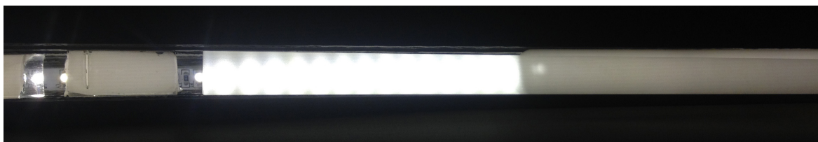
Obr.38: Testovanie intenzity, absorpcie a rozptýlenia svetla
