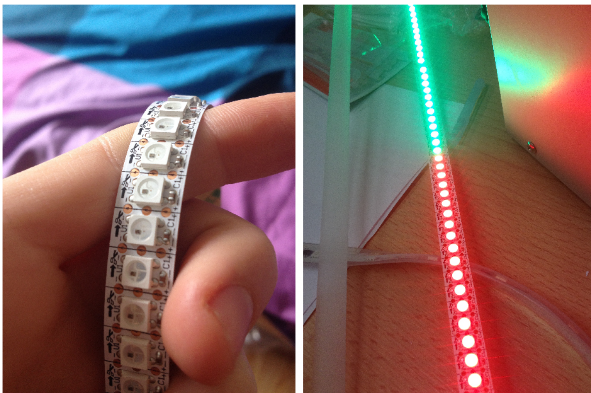
Obr.27: Zvolený digitálny RGB LED pásik s hustotou 144 LED/m
