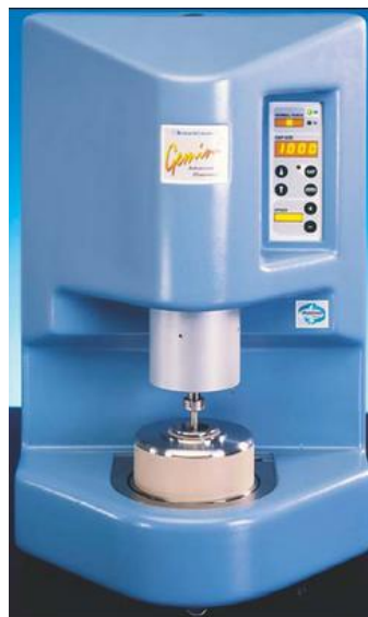
Obr. 33 Rotační viskozimetr Bohlin Gemini 150
