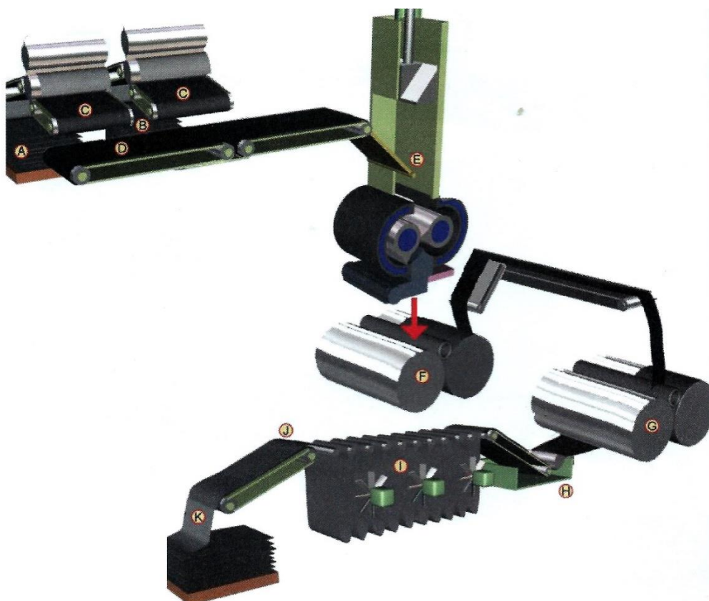
Obrázek 6: Míchací linka pro míchání finální směsi
