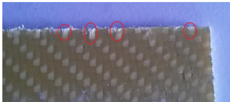
Obr. 49. Spodní strana aramidového kompozitu řezaného vodním paprskem
