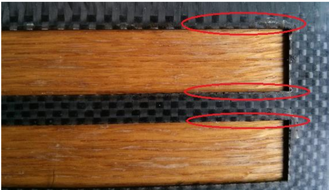
Obr. 53. Spodní strana uhlíkového kompozitu (desky) řezaného laserem
