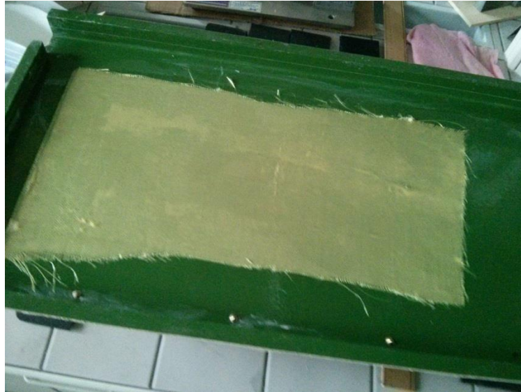
Obr. 39. Ruční laminování aramidové tkaniny
