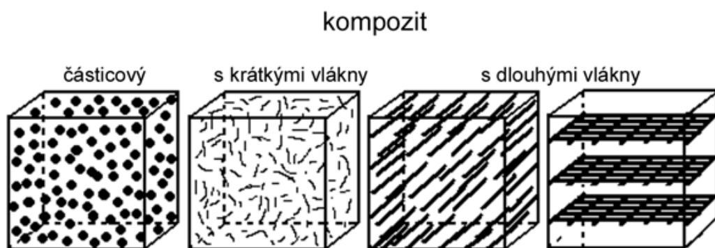
Obr. 7. Rozdělení kompozitů podle výztuže [10]
