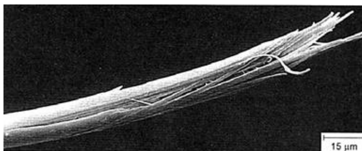
Obr. 14. Aramidové vlákno s roztřepením v místě lomu [1]
