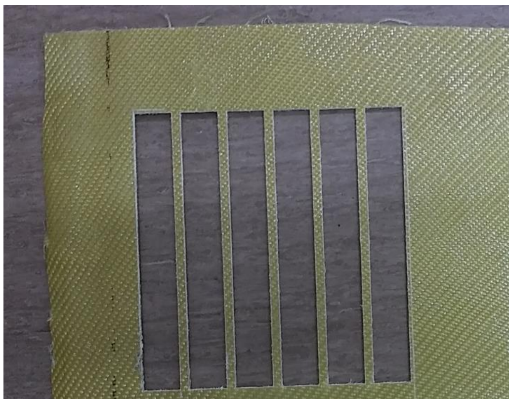
Obr. 73. Aramidová deska po vyřezání vzorků vodním paprskem
