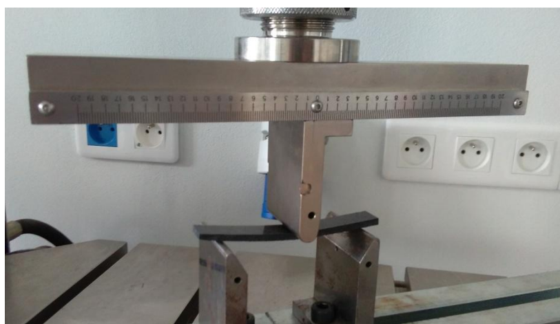
Obr. 42. Uspořádání cyklické ohybové zkoušky
