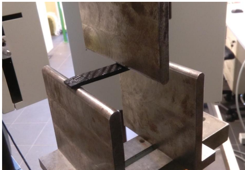
Obr. 36. Průběh statické zkoušky v ohybu na stroji ZWICK 1456
