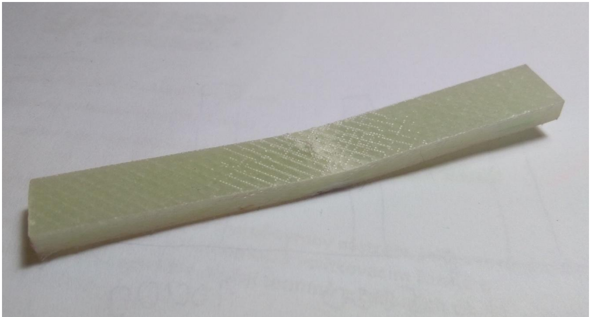
Obr. 57. Deformace zk. tělesa ze skelného prepregu po 50 000 cyklech
