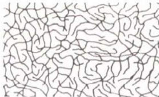
Obr. 3. Struktura amorfního termoplastu. [11]
