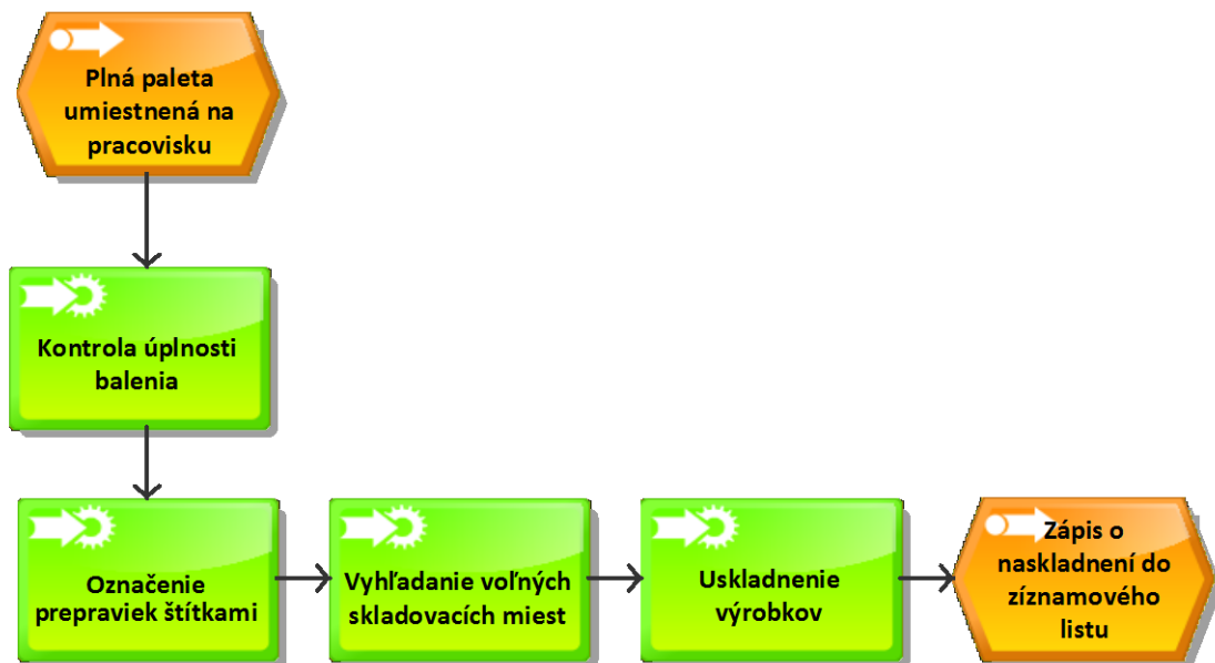
Obr. 25 Vývojový diagram spracovaný v programe ARIS Express - naskladnenie hotových výrobkov (vlastné spracovanie)
