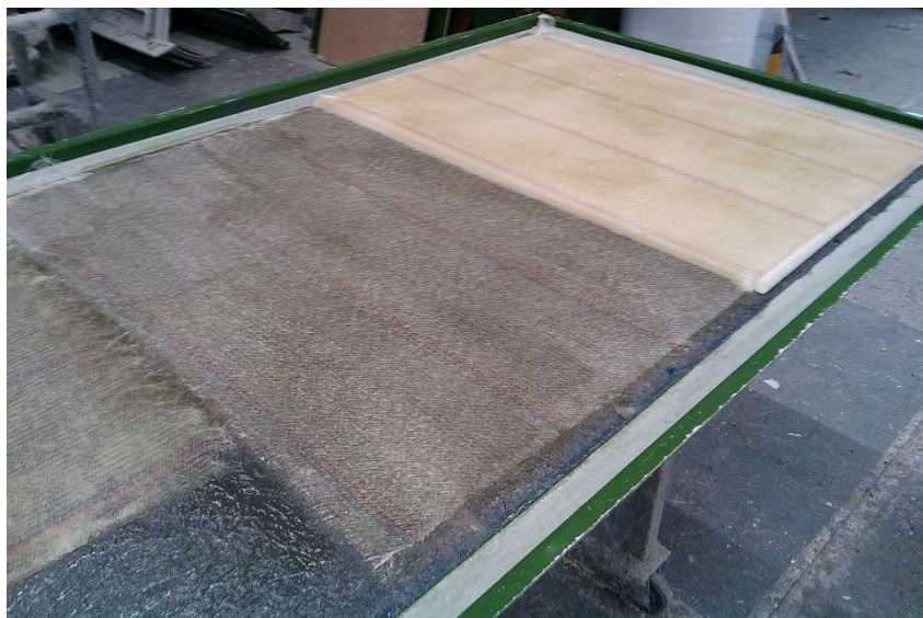
Obr. 39. Nanesení tkaniny a pryskyřice
