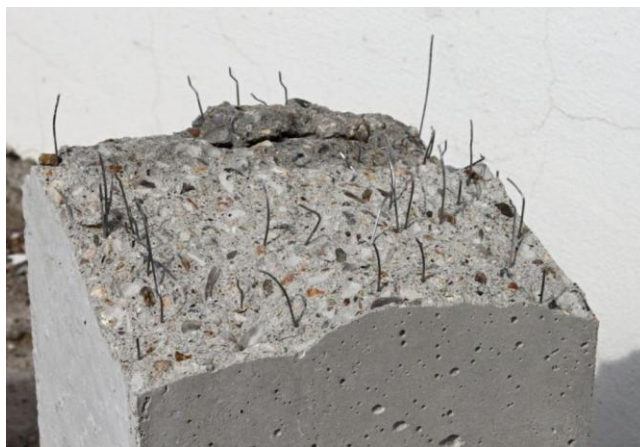
Obr. 7. Řez betonového sloupu plněný vlákny [9]
