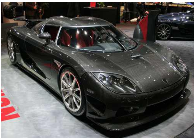
Obr. 5. Karosérie z uhlíkových vláken [7]
