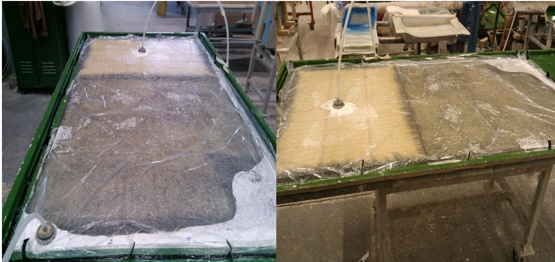
Obr. 40. Výroba sendvičového a laminátového vzorku
