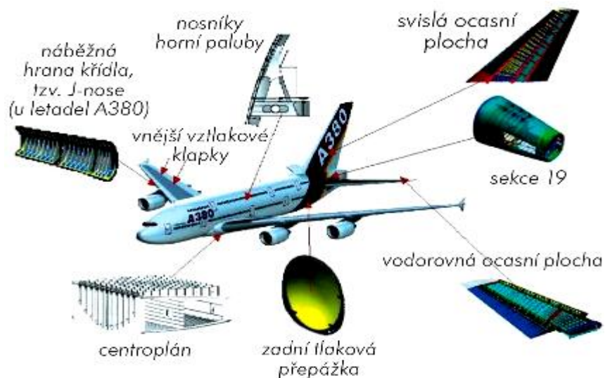
Obr. 2. Využití kompozitního materiálu v případě Airbus A380[4].
