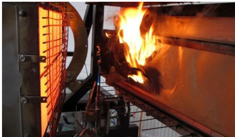
Obr. 25. Zařízení pro testování šíření plamene[21]
