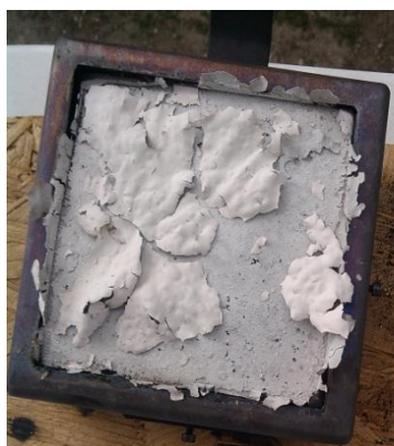
Obr. 73. Vzorek po dohoření plamene
