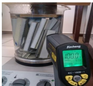
Obr. 50. Vaření vzorků při 100°C, v laboratoři FT
