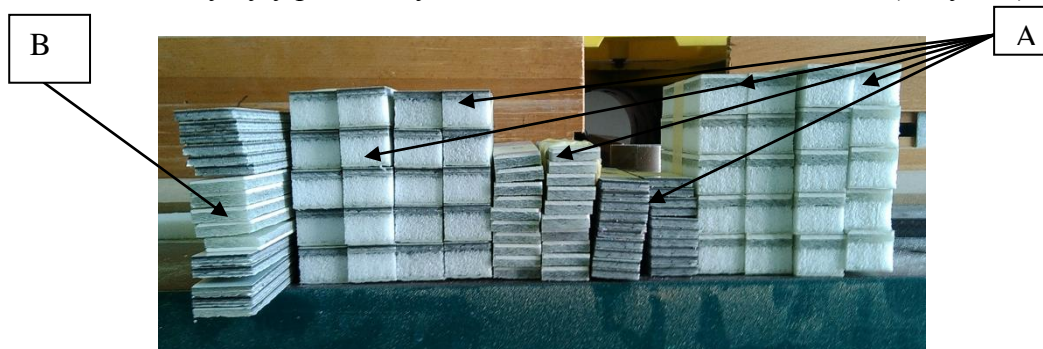
Obr. 44. Vzorky pro mechanické zkoušky: A) ohyb, B) tah
