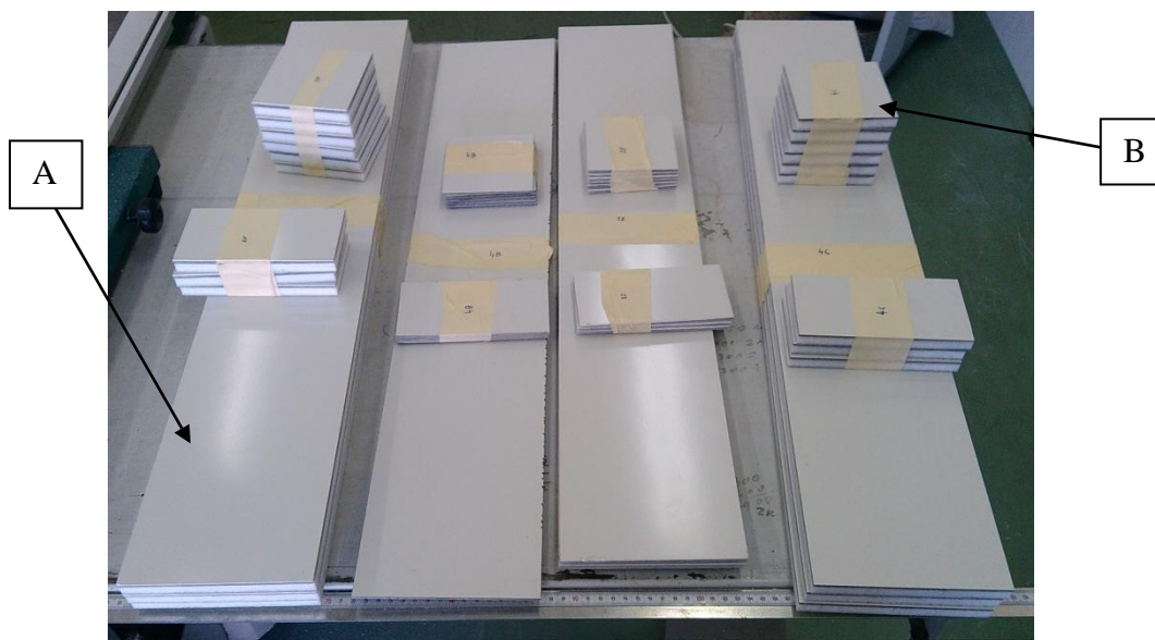
Obr. 42. Nařezané vzorky pro zkoušky: A) šíření plamene, B) kónický kalorimetr,
