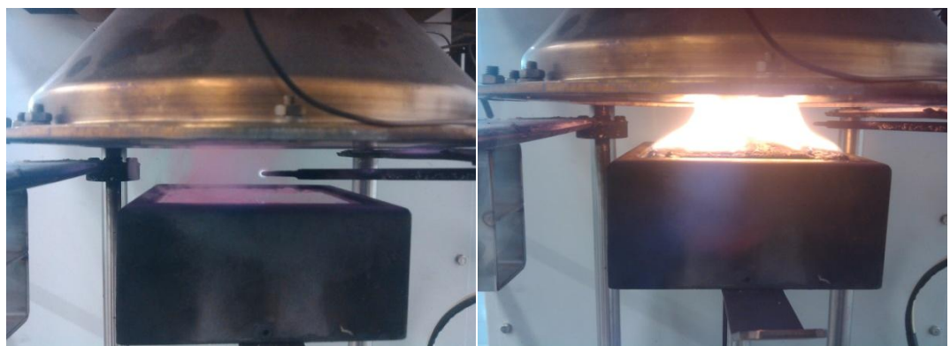
Obr. 71. Jiskrový iniciátor (vlevo) a zapálení vzorku (vpravo)
