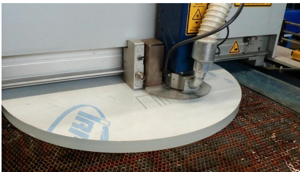
Obr. 40 – Fotografie z procesu řezání laserem u PMMA
