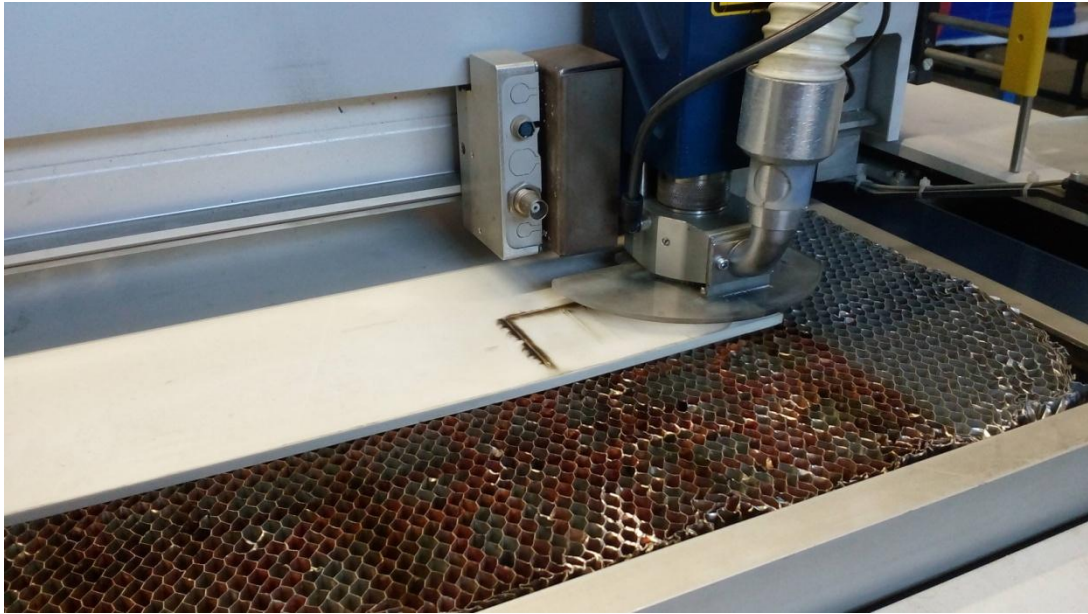
Obr. 44 – Fotografie z procesu řezání laserem HPS
