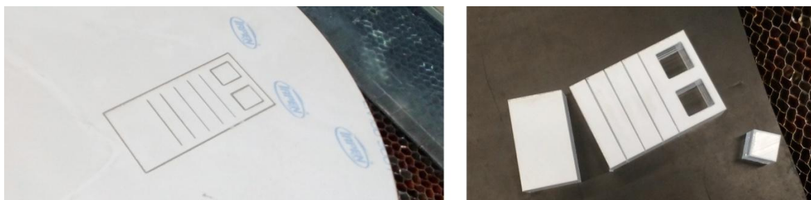
Obr. 41 – Fotografie vzorku z PMMA po řezání laserem
