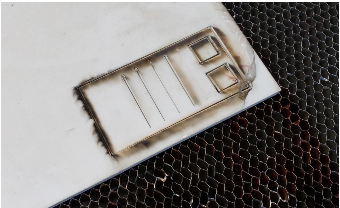
Obr. 45 – Fotografie vzorku z HPS po řezání laserem
