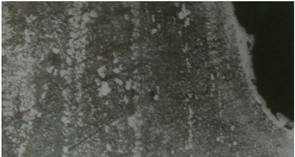
Obr. 79 – Výkon P_3 = 290W ; posuvová rychlost v_5 = 0,30 m/min; zvětšení 200x
