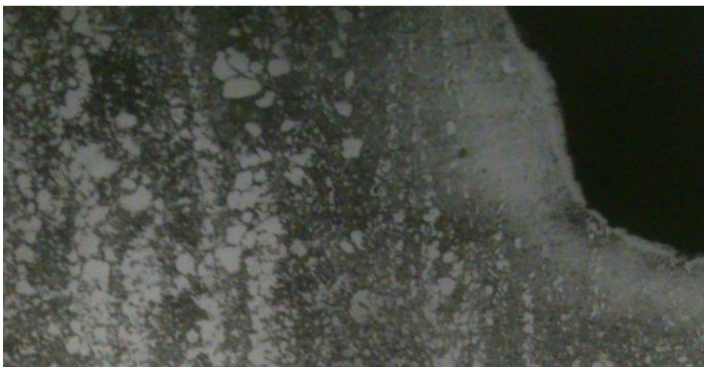
Obr. 77 – Výkon P_4 = 335W ; posuvová rychlost v_5 = 0,30 m/min; zvětšení 200x
