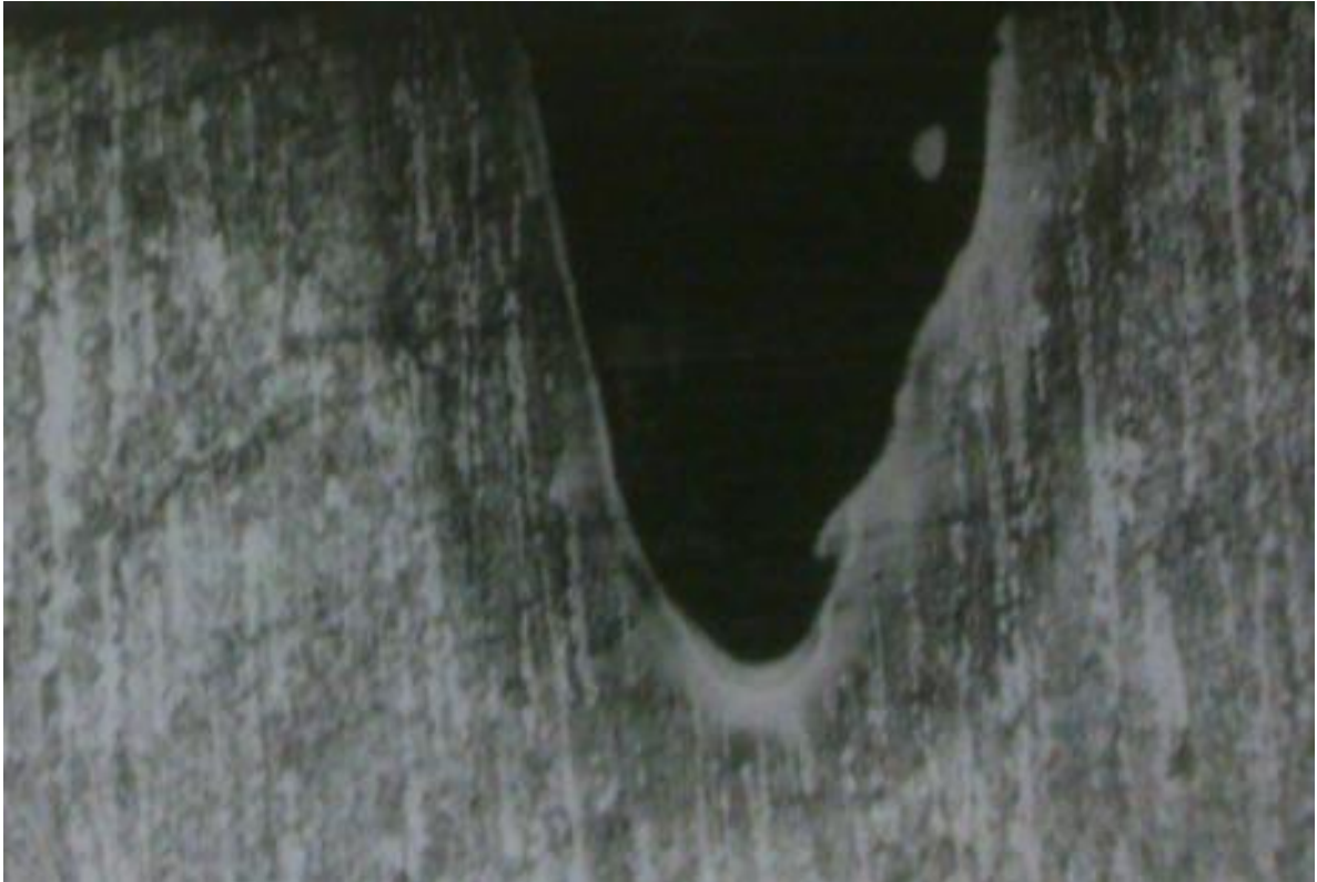
Obr. 84 – Ocel 19 824.1; výkon P_4=335W ; posuvová rychlost v_2 = 0,10m/min ; zvětšení 50x
