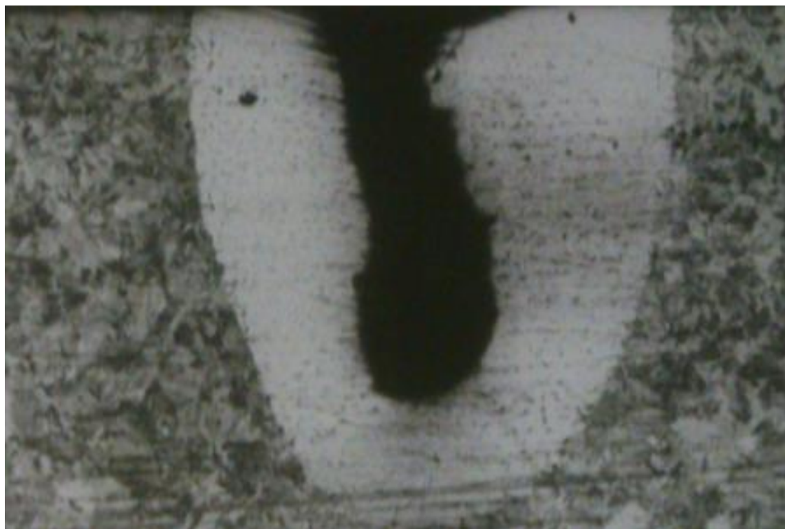
Obr. 82 – Ocel 12 060.1; výkon P_3=290W ; posuvová rychlost v_2 = 0,10m/min ; zvětšení 50x
