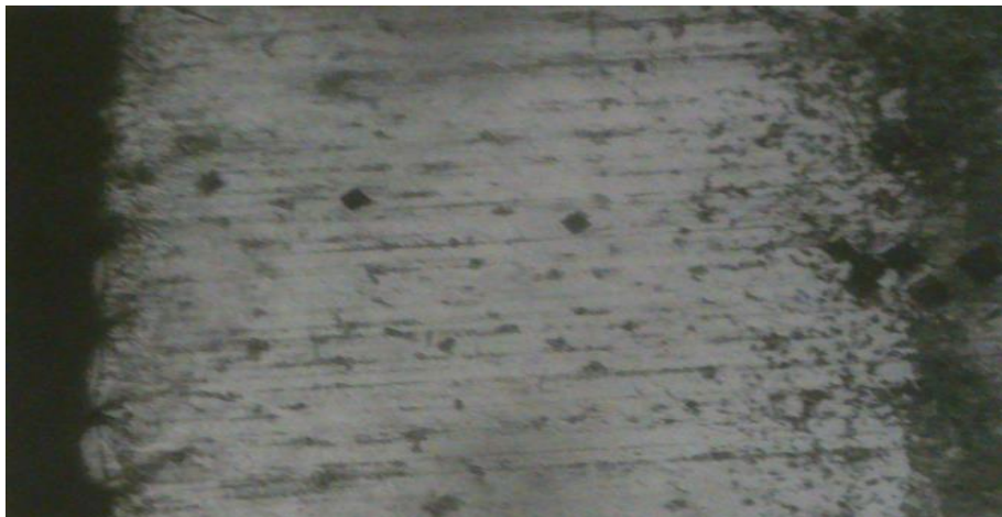
Obr. 70 – Výkon P_3 = 290W ; posuvová rychlost v_1 = 0,05 m/min; zvětšení 200x
