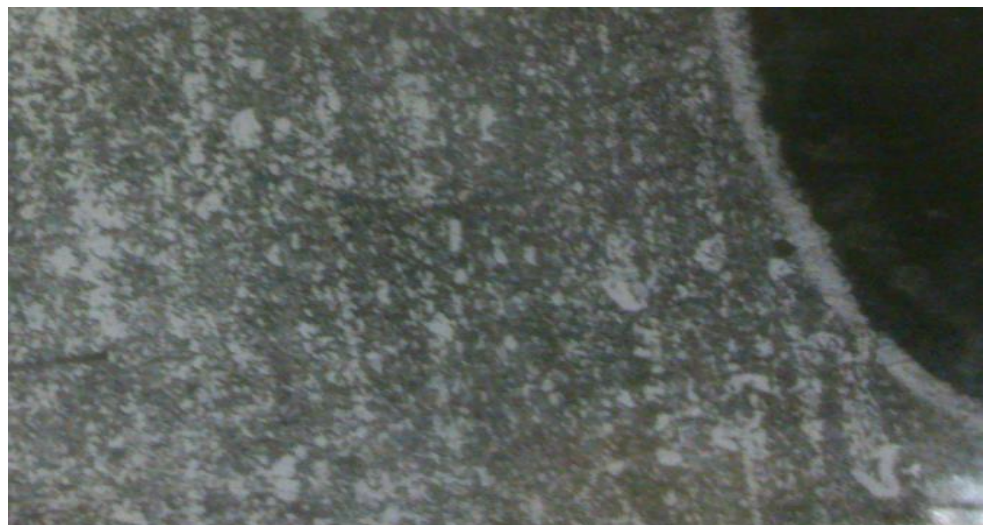
Obr. 80 – Výkon P_2 = 250W ; posuvová rychlost v_1 = 0,05 m/min; zvětšení 200x
