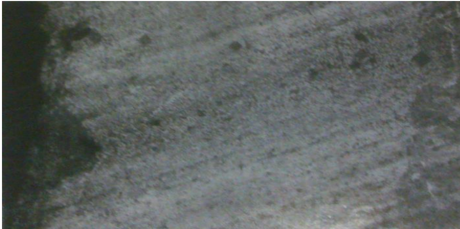
Obr. 72 – Výkon P_2 = 250W ; posuvová rychlost v_1 = 0,05 m/min; zvětšení 200x
