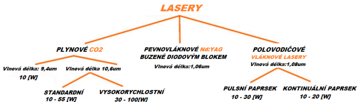
Obr. 4 – Schéma rozdělení laserů podle aktivního prostředí [11]
