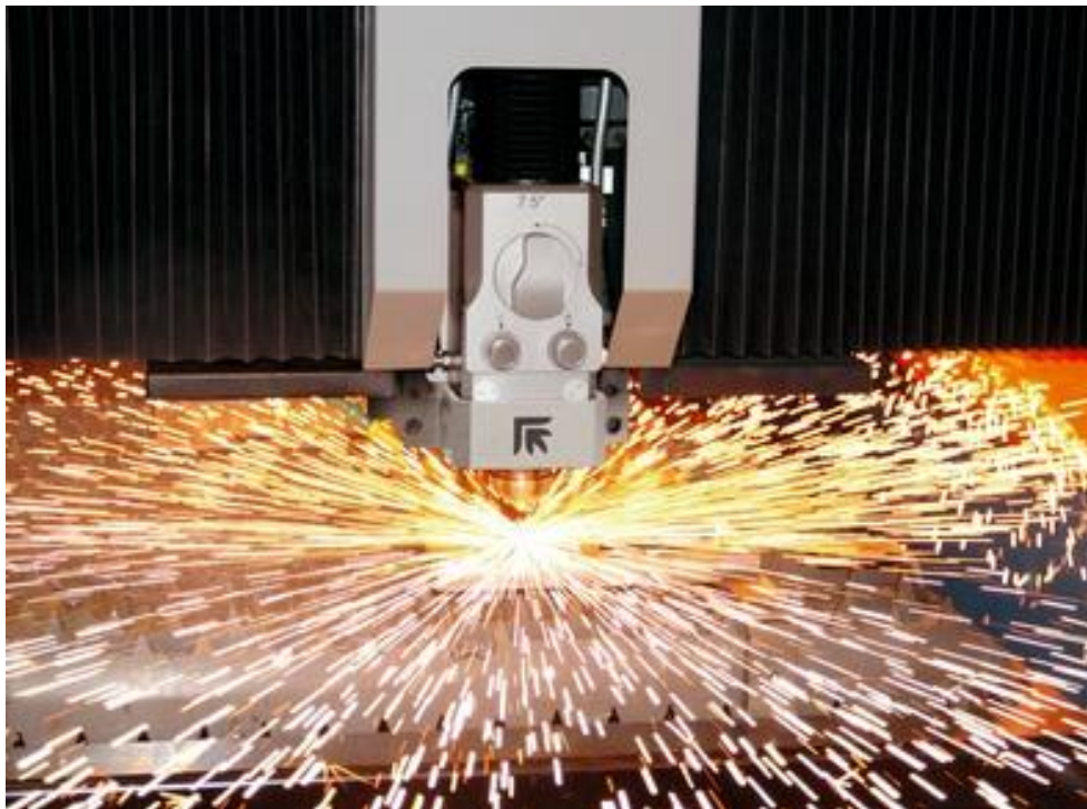
Obr. 42 – Laserové řezání plechu na stroji Platino 1530
