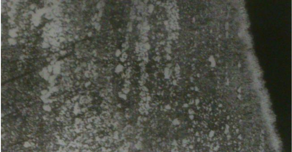
Obr. 78 – Výkon P_4 = 335W ; posuvová rychlost v_1 = 0,05 m/min; zvětšení 200x
