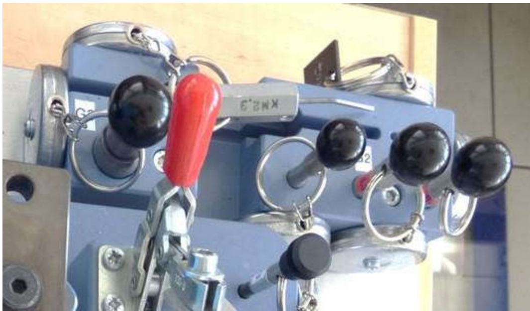
Obr. 60. Upevnění kalibru pomocí navijáku
