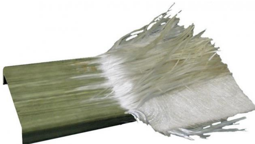
Obr. 3.7 Tažený profil vyztužený skleněnými vlákny [19].
