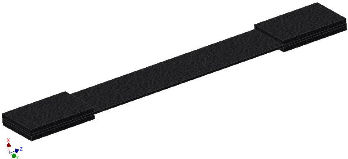
Obr. 6.5 3D model zkušebního tělesa pro tahovou zkoušku.
