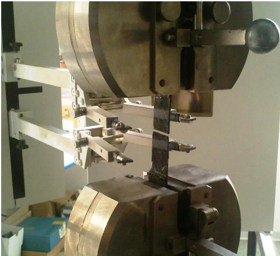
Obr. 7.2 Sklíčidla stroje ZWICK 1456 po roztržení zkušebního vzorku [42].
