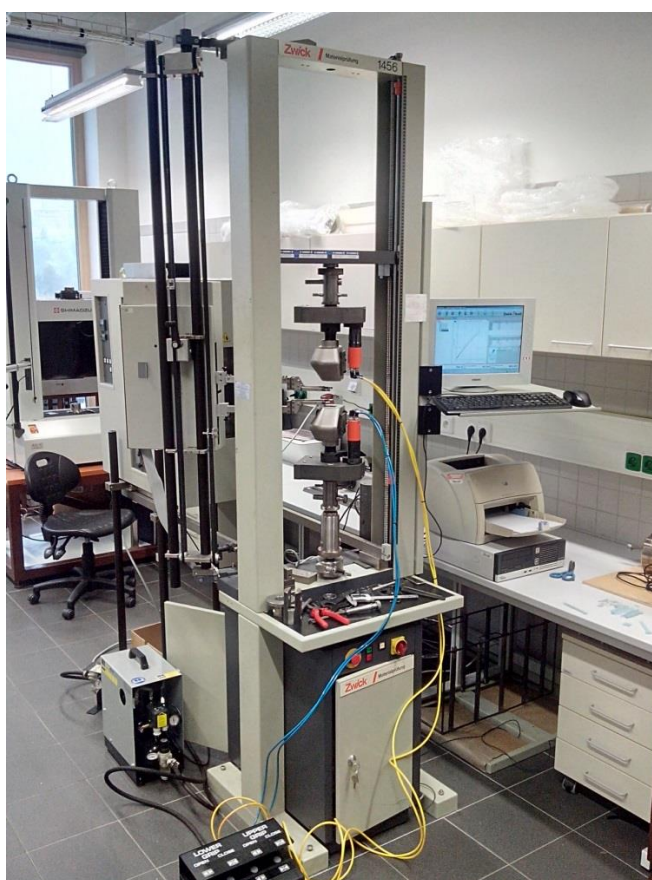
Obr. 7.1 Univerzální zkušební stroj ZWICK 1456.
