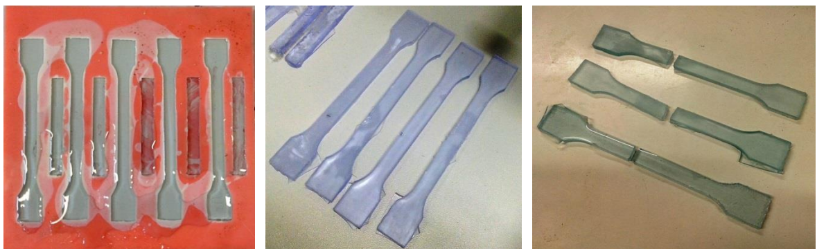
Obr. 8.3 Proces výroby a testování zkušebních těles z pryskyřice Havel L 285.
