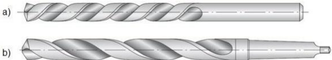
Obr. 21 Šroubovitě vrtáky s válcovou a kuželovou stopkou [44]
