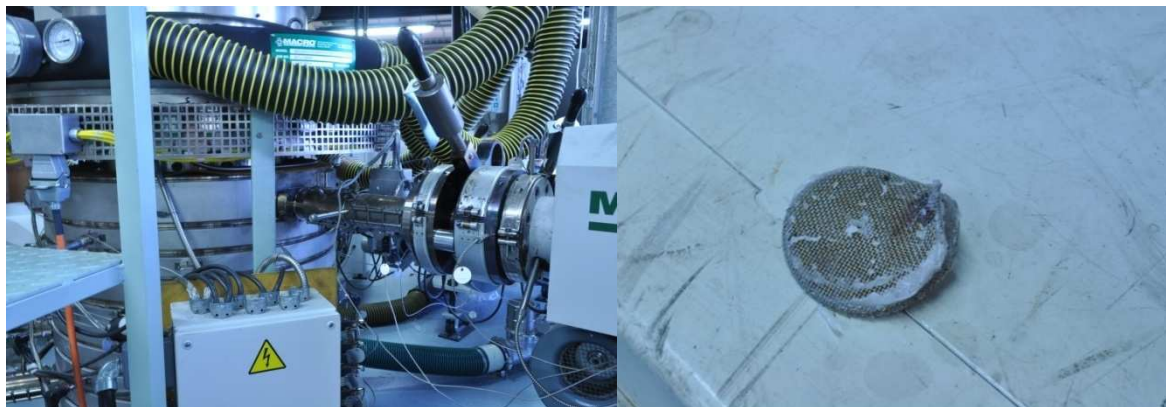
Obr.3a- pákový mechanismus výměny sít,3b- zanesená síta
