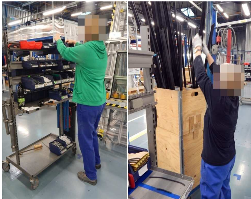
Obr. 21 Nevhodná výška zásobovacího regálu a vozíku na pozicích 1 a 2 (vlastní zpracování)
