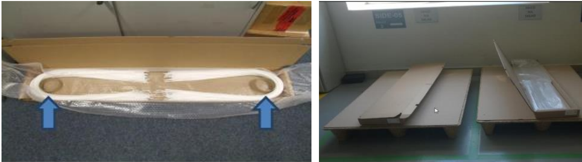
Obr. 18 Znárodnění umístění optických vláken do smyčky paralelně proti sobě a způsob umístění kartonových krabic do skladovacího místa (vlastní zpracování)
