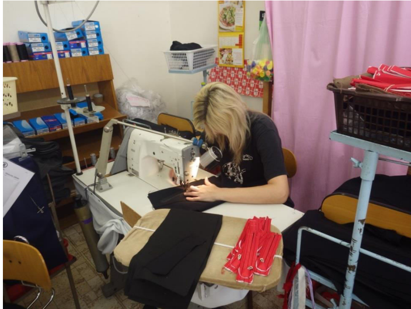
Obrázek 11 Sešívání krokového švu a přišívání zipu (vlastní foto)
