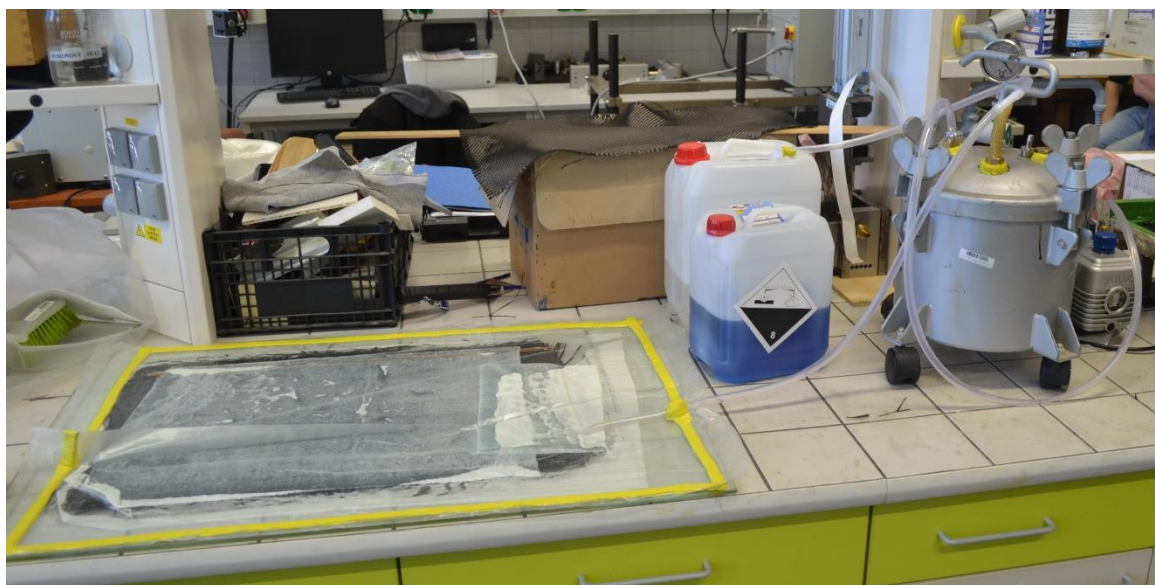
Obr. 40 Za vakuovaný kompozitní systém včetně přepadové nádoby a vývěvy
