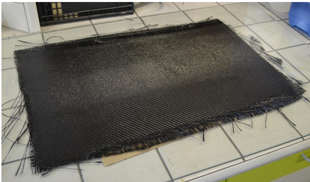
Obr. 37 Ručně laminovaný kompozitní systém připravený pro vakuovací fólii
