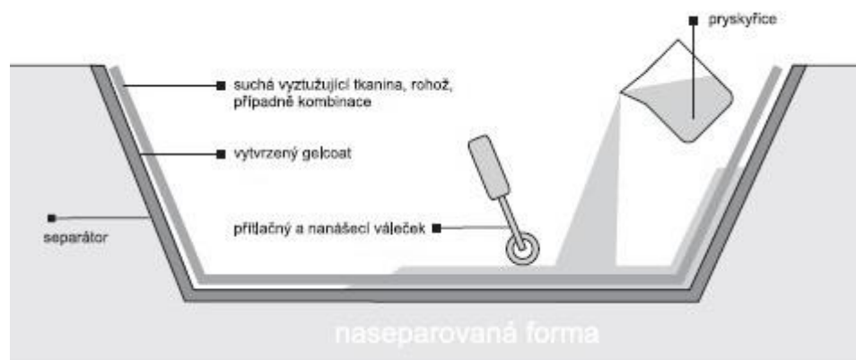
Obr. 20 Schéma ručního laminování
