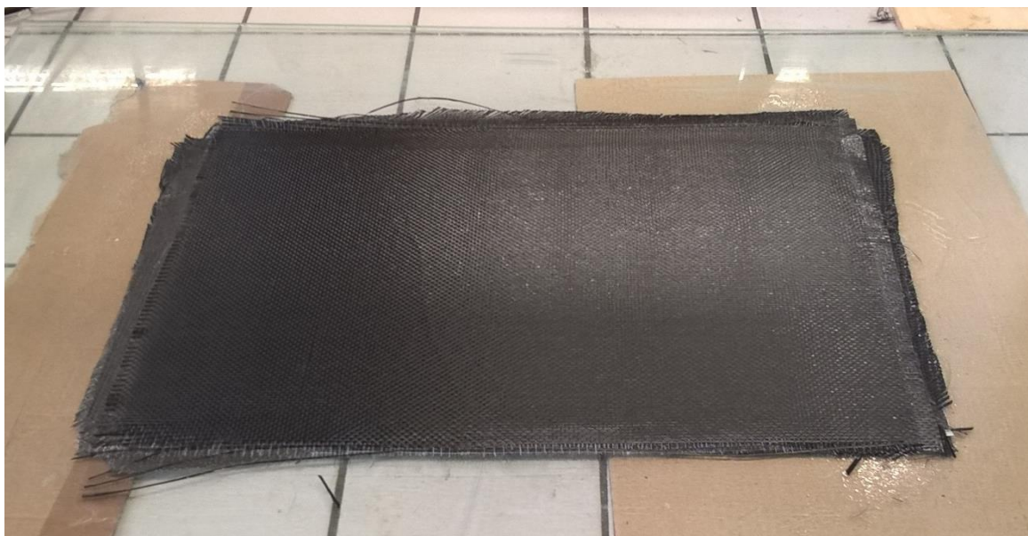
Obr. 35 Příklad vyrobeného laminátu (ruční laminace) o rozměrech 500mm x 300mm
