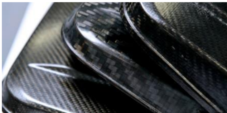
Obr. 18 Vizuální porovnání uspořádání tkanin na výrobku
