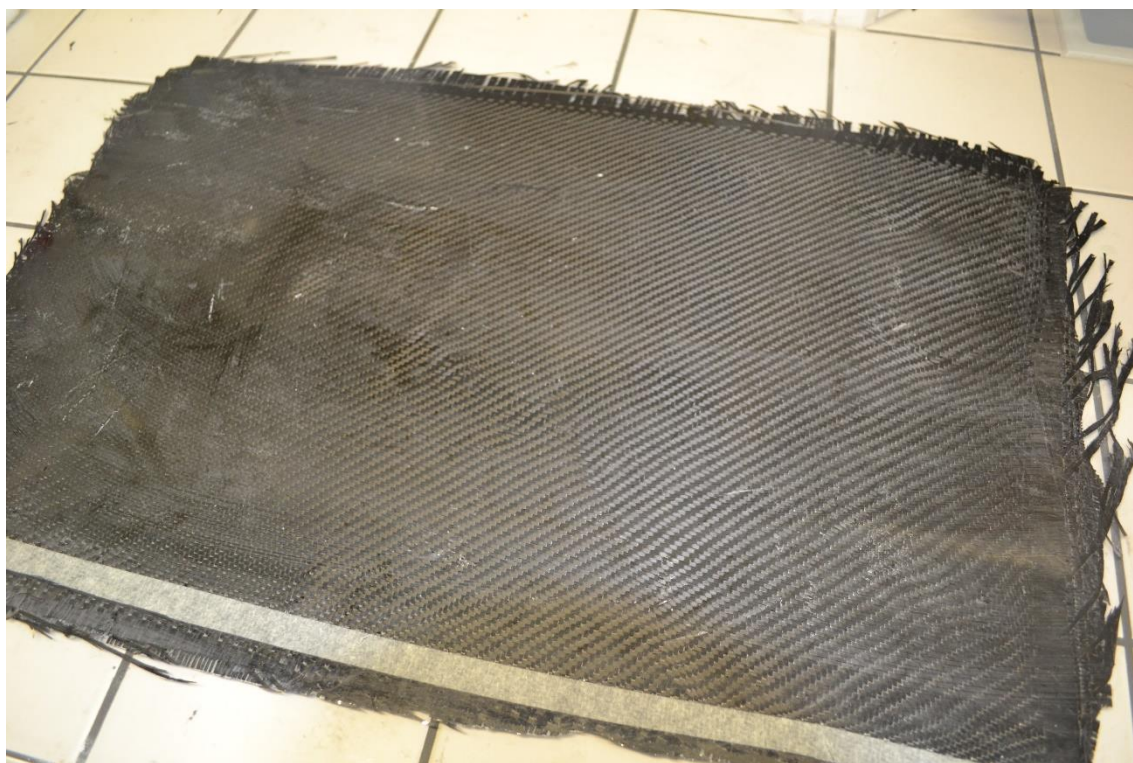
Obr. 41 Příklad vyrobeného laminátu (pod vakuovou folii) o rozměrech 500mm x 300mm
