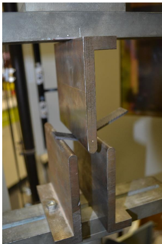
Obr. 44 Zkušební těleso při zkoušce ohybem
