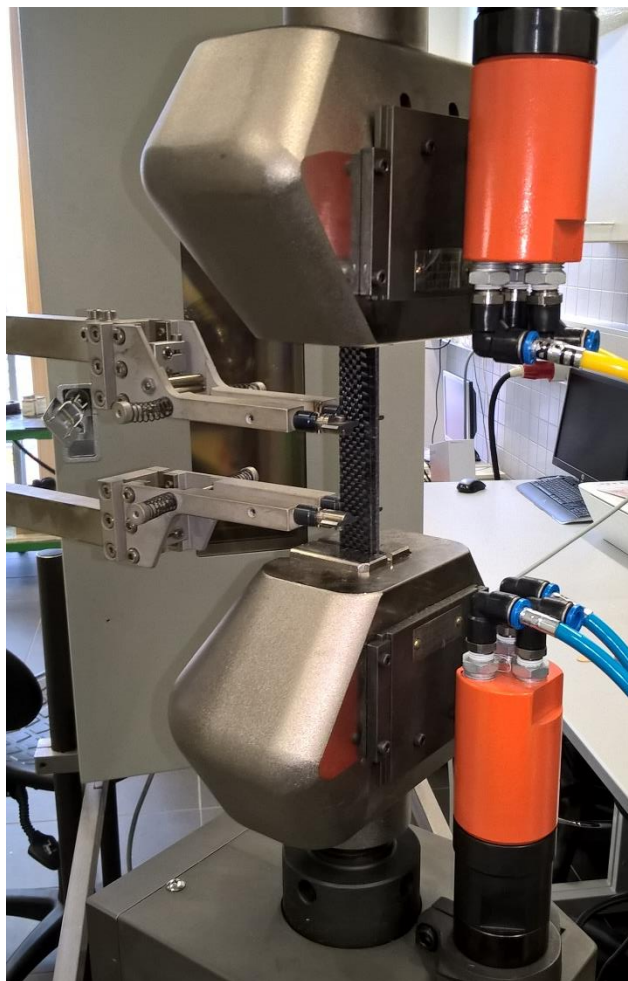
Obr. 53 Zkušební těleso při zkoušce tahem
