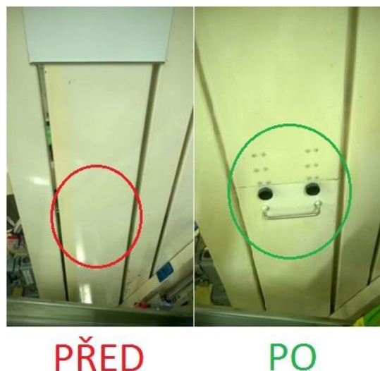
Obr. 28 Vytvoření snímatelného krytu na vkladu (vlastní zpracování)
