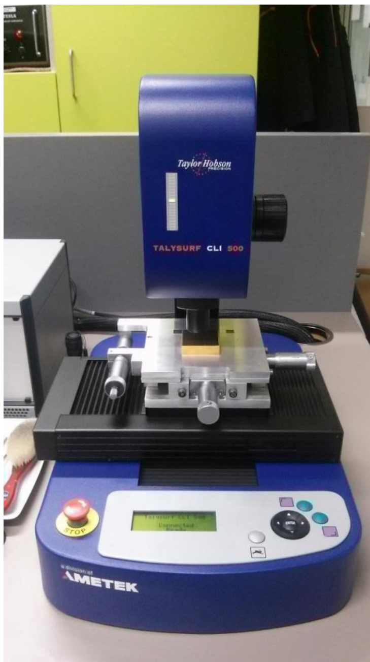
Obr. 32 Upevnění měřeného vzorku
