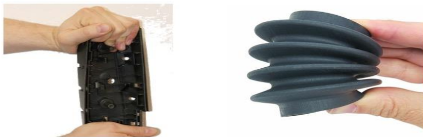
Obr. 2 Chování polymerů při mechanickém namáhání plast (vlevo), elastomer (vpravo) [1]
