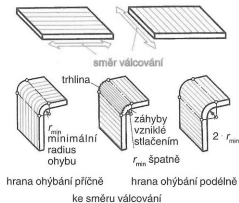
Obrázek 4: Směr vláken materiálu vůči hraně ohybu[5]
