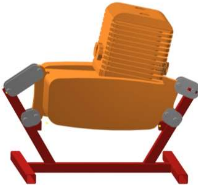
Obr. 27 Montážní stolice s pevným rámem a uchyceným motorem
