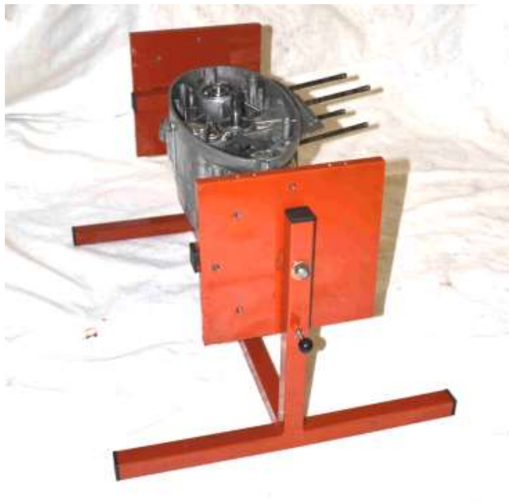
Obr. 43 Montážní stolice a upevněný a otočený motor
