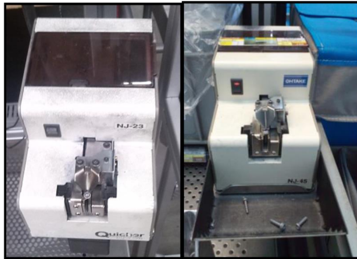
Obrázok 57: Upravený podávač na šrouby (Vlasté spracovanie)
