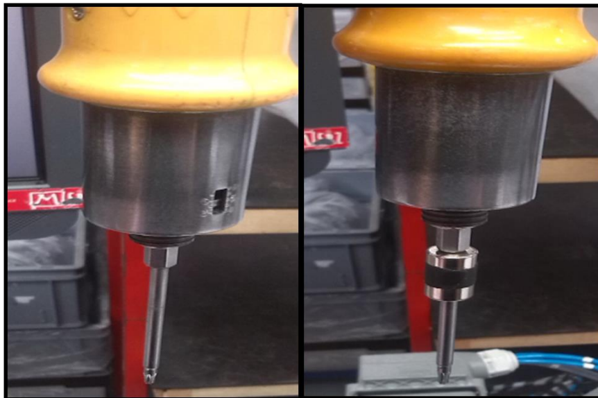
Obrázok 58: šroubovák s magnetom (Vlasté spracovanie)
