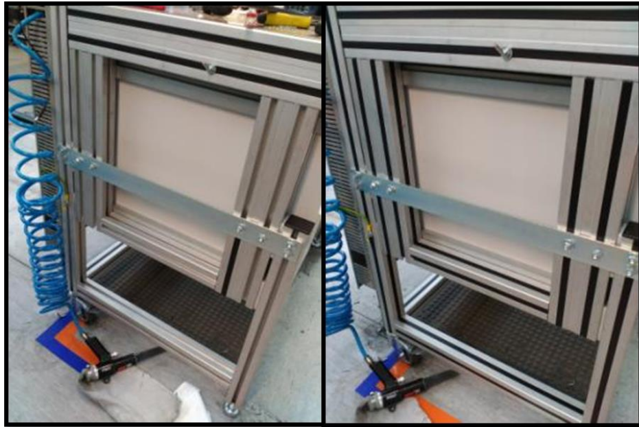
Obrázok 59: zakrytovanie bosch profilov (Vlasté spracovanie)
