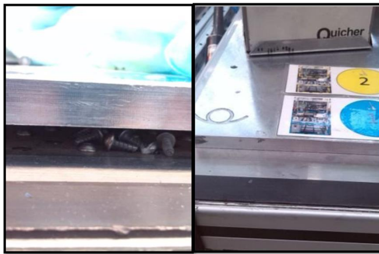
Obrázok 61: Zakrytovanie ťažko prístupnej oblasti (Vlasté)
