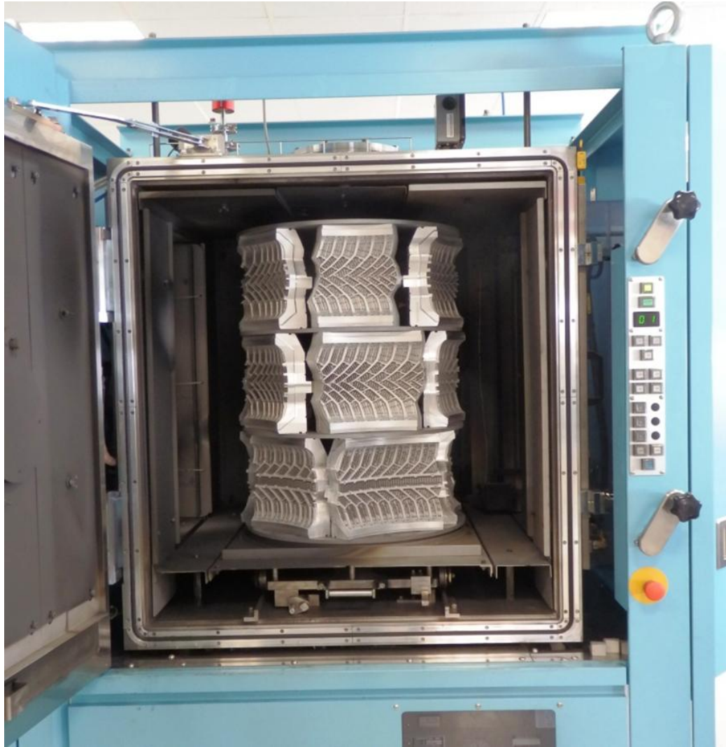
Obr. 22 Připravené segmenty k povlakování v komoře
