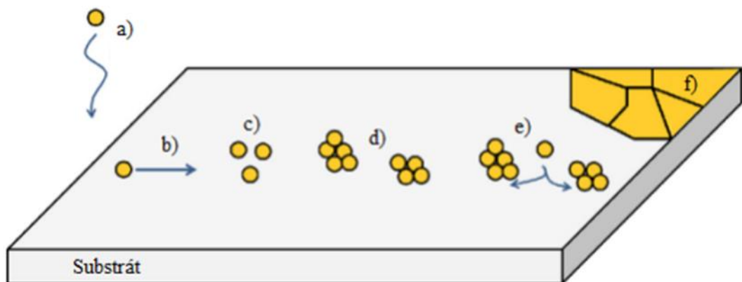
Obr. 1 Schéma postupného vzniku povlaku [3]
