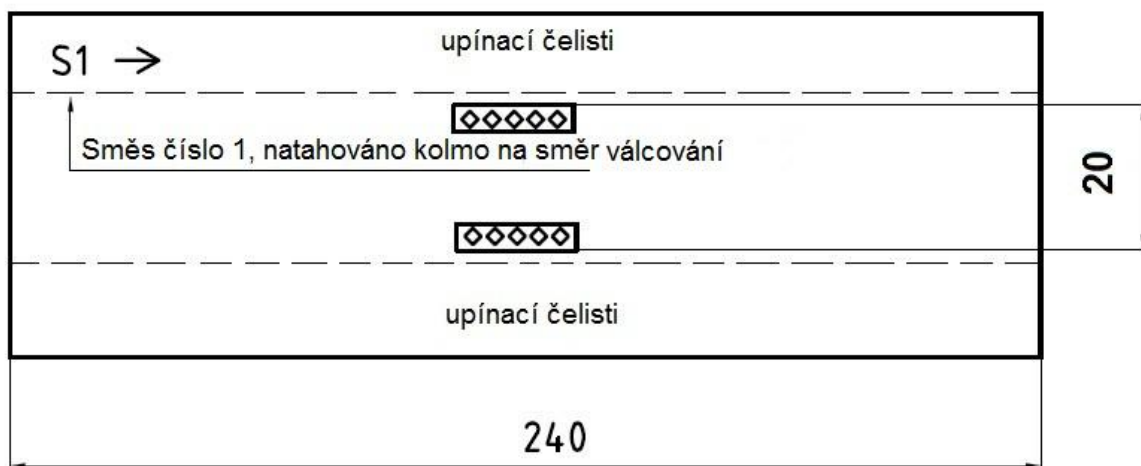
Obrázek 12: Schéma vystřiženého zkušebního tělíska pro čistý smyk
