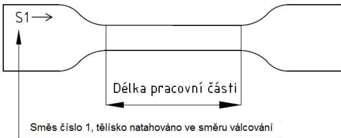
Obrázek 13: Schéma zkušebního tělíska pro zkoušku tahem
