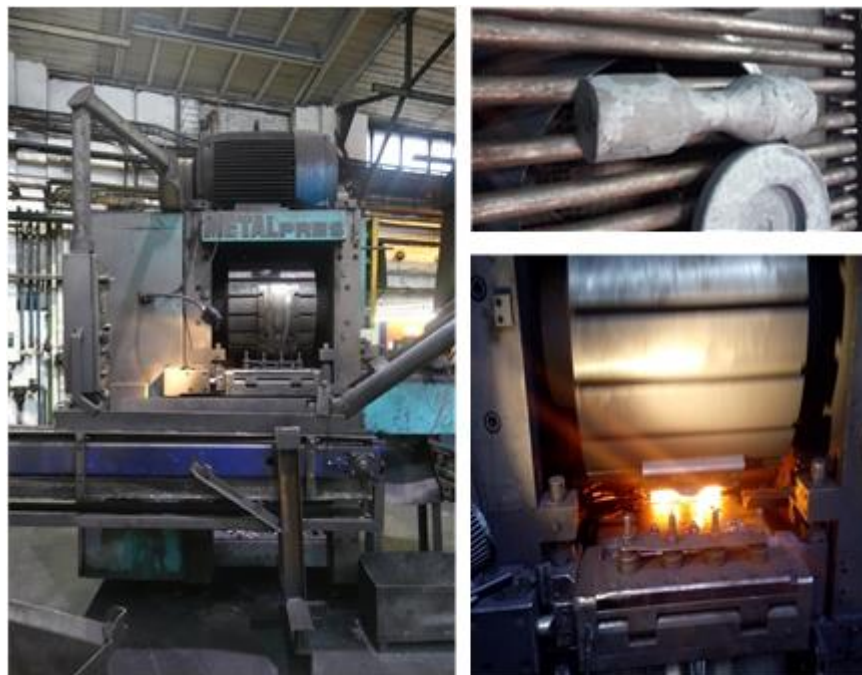
Obr. 18 Ukážka valcovacieho stroja, valcovacieho procesu a odvalku (vlastné spracovanie)
