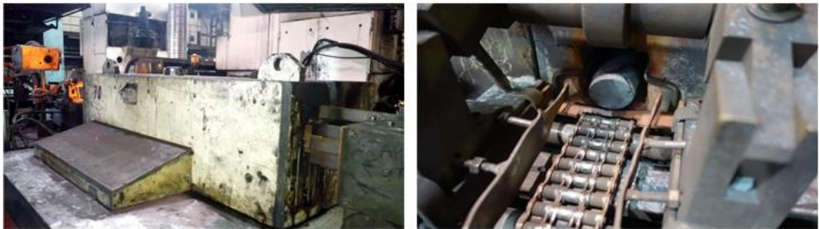
Obr. 15 Ukážka induktoru a prechodu hutného polotovaru induktorom (vlastné spracovanie)
