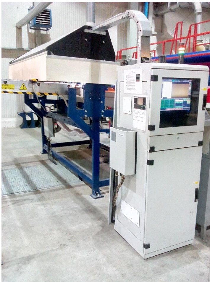
Obr. 15: Kontrolní kamerový systém extruzní linky Q1 (vlastní zpracování)
