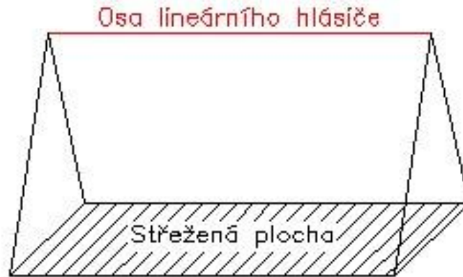
Obr. 13 Střežená plocha lineárního hlásiče
