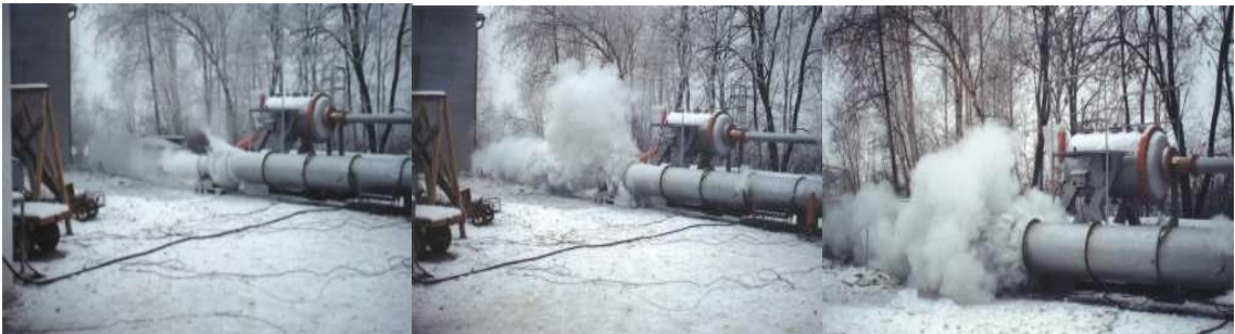
Obr. 55 Výbuch s použitím HRD bariéry
