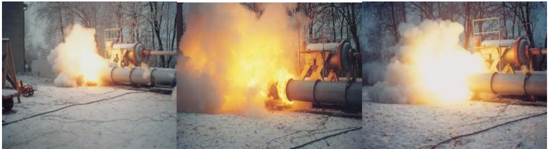
Obr. 56 Výbuch bez použití HRD bariéry
