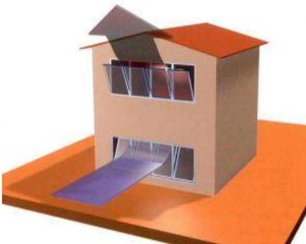
Obr. 66 Přívod čerstvého vzduchu a odvod spalin
