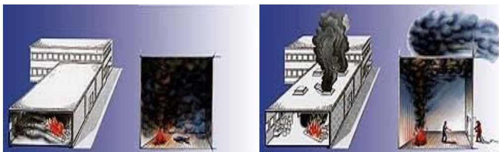
Obr. 63 Chování kouře bez systému odvětrání / se systémem odvětrání
