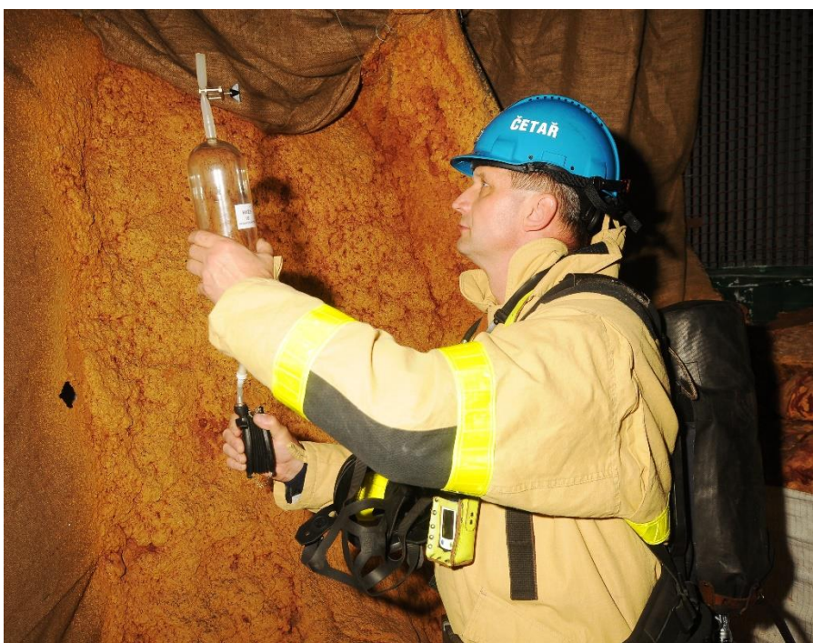
Obrázek 17 Ukázkou odběru suchého vzorku do skleněné vzorkovnice za pomoci harmonického nasávače.
