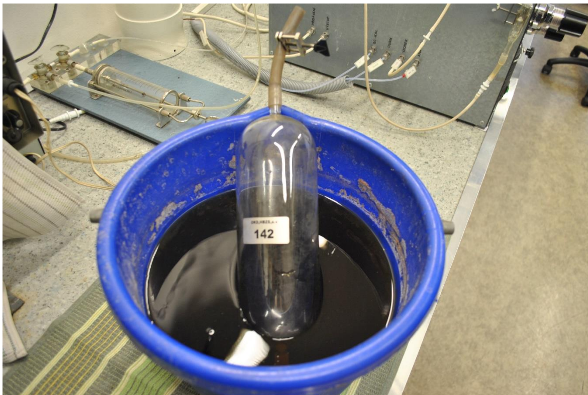
Obrázek 43 Skleněná vzorkovnice s odebraným vzorkem důlního ovzduší, který je ponořen v nádobě s roztokem.
