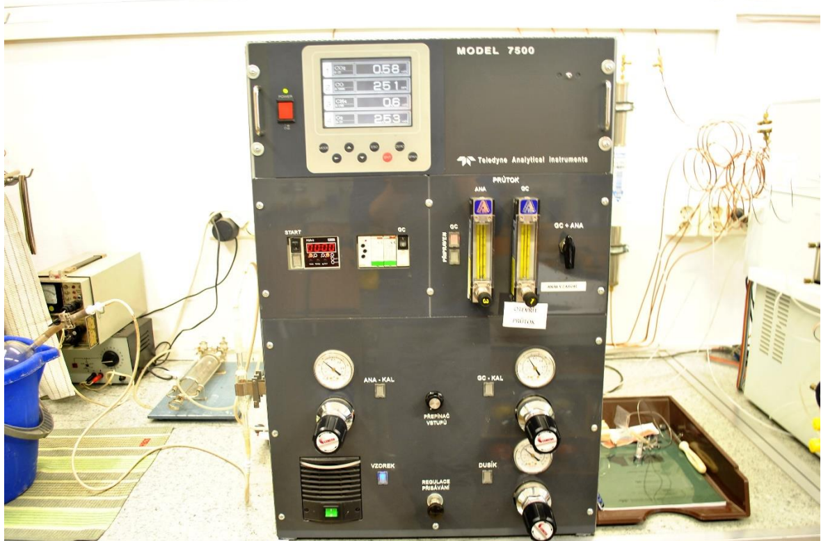
Obrázek 31 Infračervený analyzátor plynů TELEDYNE MODEL 7500.
