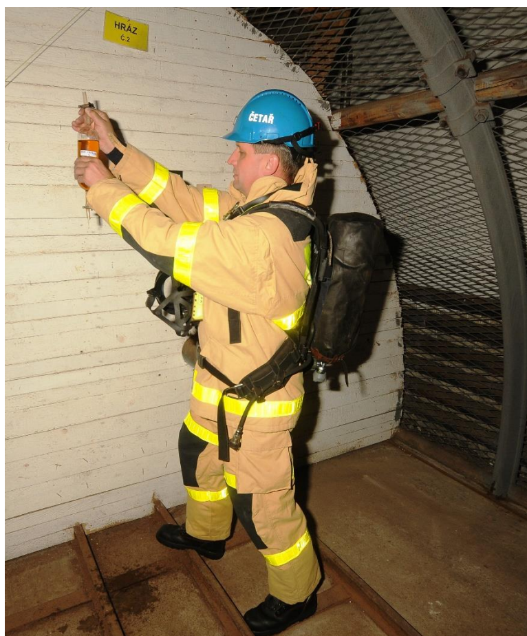
Obrázek 16 Ukázka mokrého odběru za pomoci uzávěrné kapaliny.
