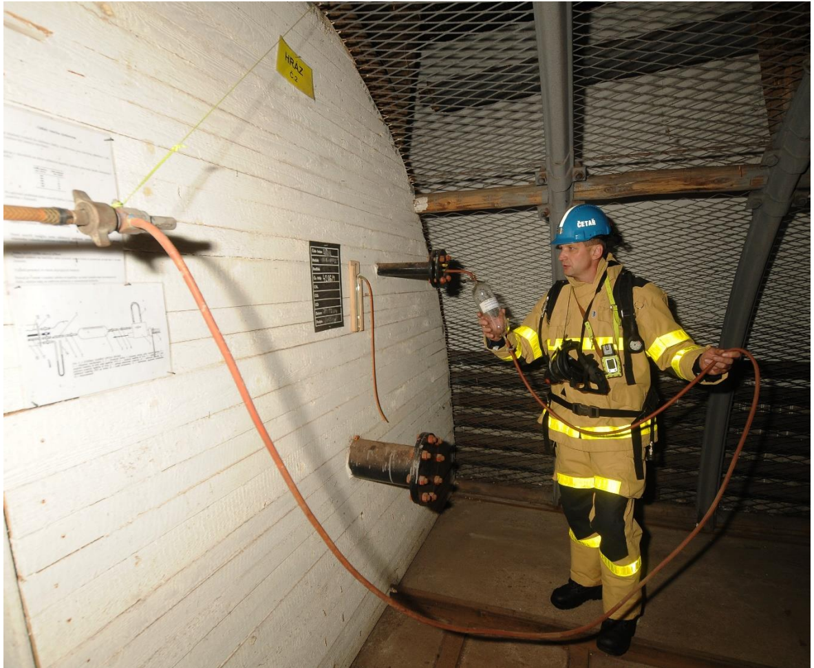
Obrázek 23 Ukázka odběru vzorku důlního ovzduší pomocí ejektoru.
