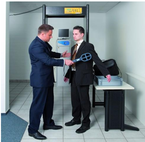
Obrázek č.12: Ruční detekce kovových předmětů [ Zdroj 37]
