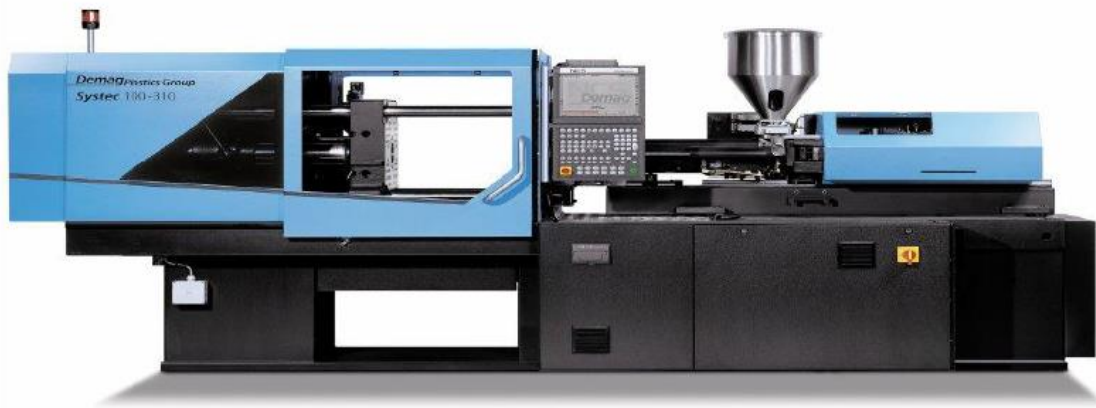
Obr. 17. Strojní vybavení – vstříkolis [33]
