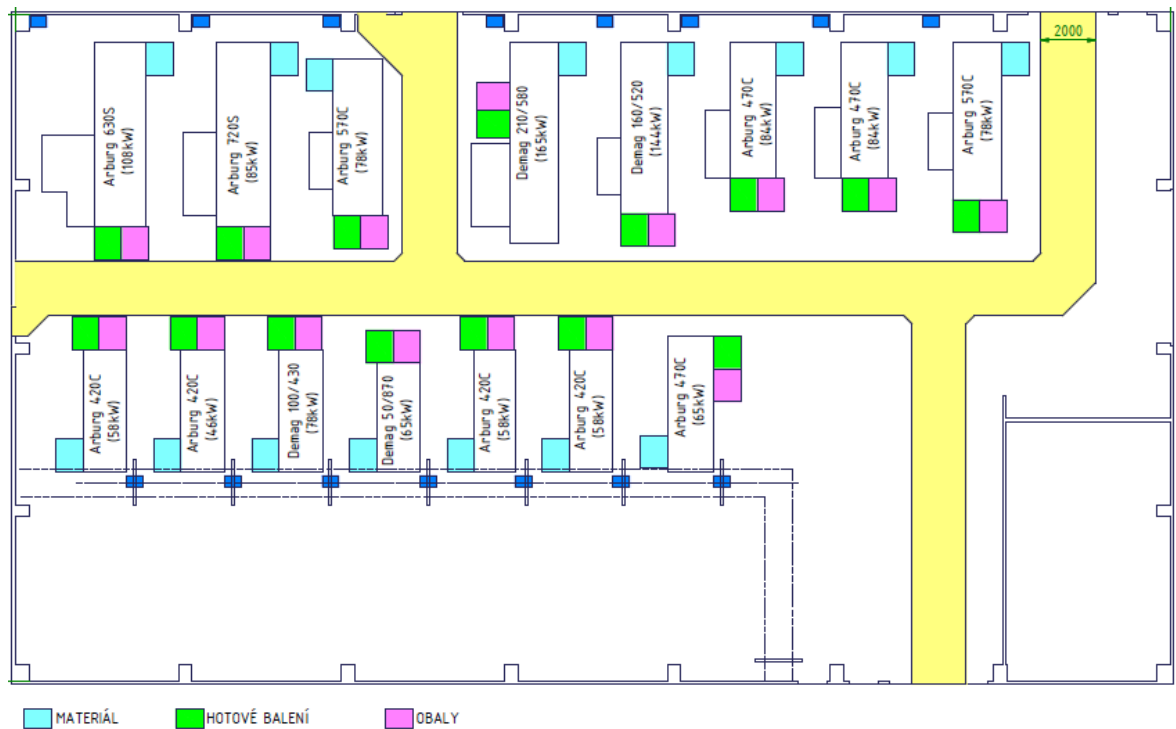
Obr. 6. Lay out strojů a pracovišť [zdroj firma Kovoplast]
