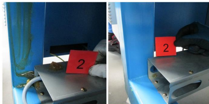
Obrázok 35: Počiatočné čistenie – únik vazelíny mimo stroj. Situácia pred a po odstránení problému. (Zdroj: vlastné spracovanie)
