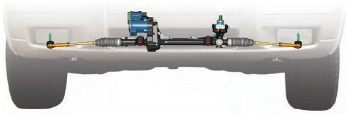
Obrázok 14: Zobrazenie Belt Drive po montáži do automobilu. Zdroj: (ZF TRW, 2015b)
