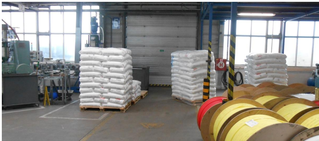
Obrázek 14: Nevhodné umístění materiálu, přebytečný materiál
