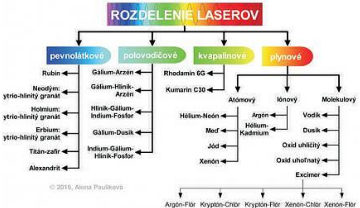
Obr. 12 Rozdelenie laserov podľa povahy aktívneho prostredia [9]
