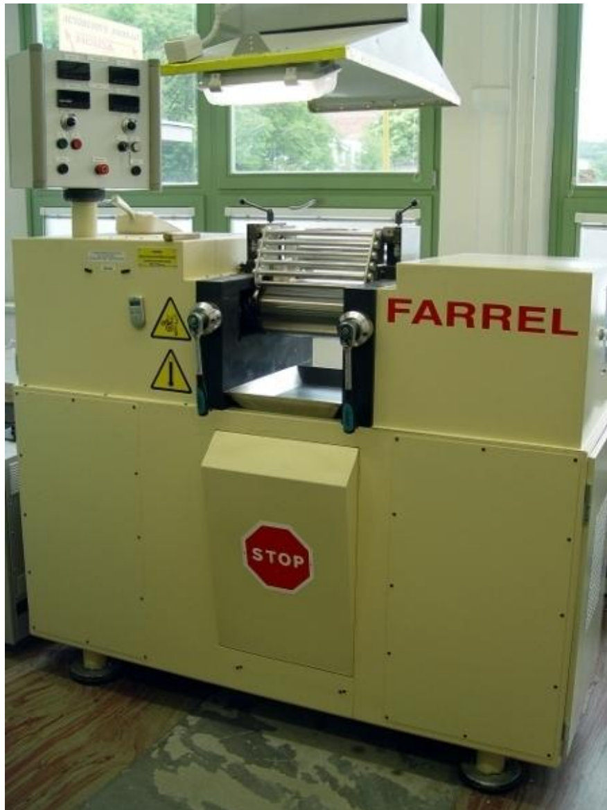
Obrázek 18: Dvouválec Farrel G-2603 150x330 mm (Univerzita Tomáše Bati ve Zlíně: Fakulta technologická, ©2016)
