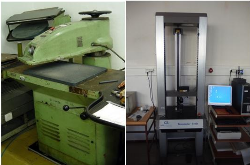
Obrázek 21: Hydraulický vysekávací stroj ZPS 06102 P1 a trhací zařízení Tensometer T10D pro vyhodnocování tahových vlastností vzorků (Univerzita Tomáše Bati ve Zlíně: Fakulta technologická, ©2016)
