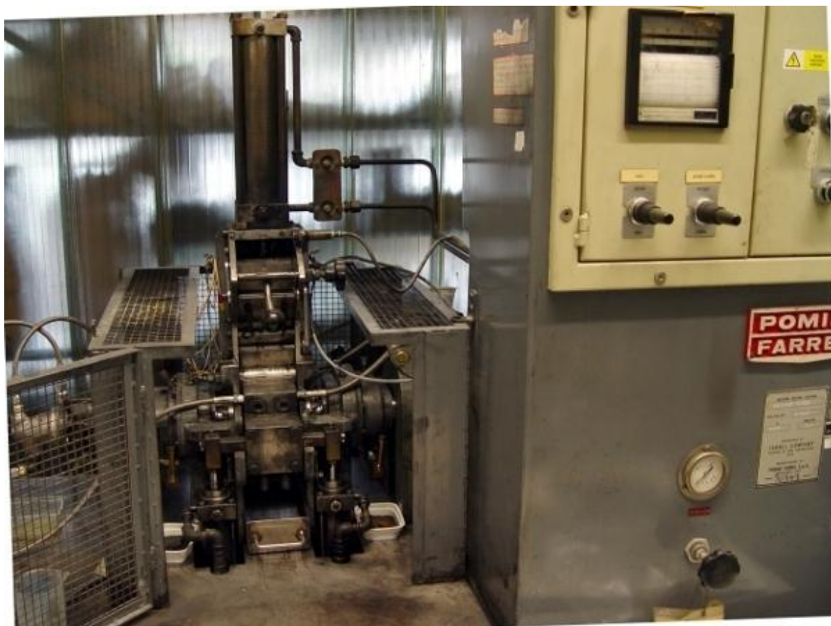
Obrázek 17: Hnětič pro míchání kaučukových směsí s externím ohřevem a chlazením (Univerzita Tomáše Bati ve Zlíně: Fakulta technologická, ©2016)
