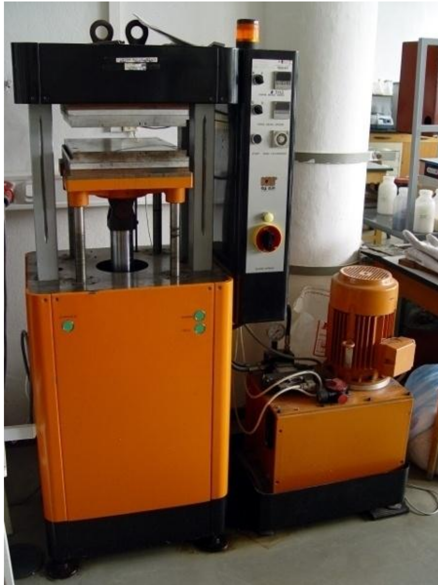
Obrázek 20: Hydraulický vulkanizační lis IGTT (Univerzita Tomáše Bati ve Zlíně: Fakulta technologická, ©2016)
