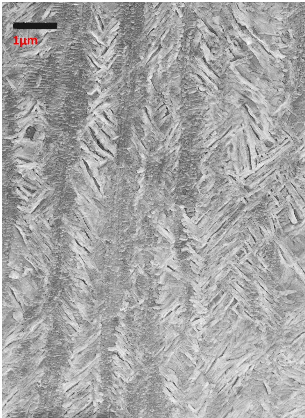
Obr. 22 e- orientovaná směs izotaktického polypropylenu (30%) a lineárního polyethylenu (70%)
