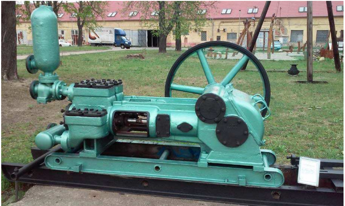
Obrázek 17: LPV Čerpadlo 4x6 [vlastní zdroj]
