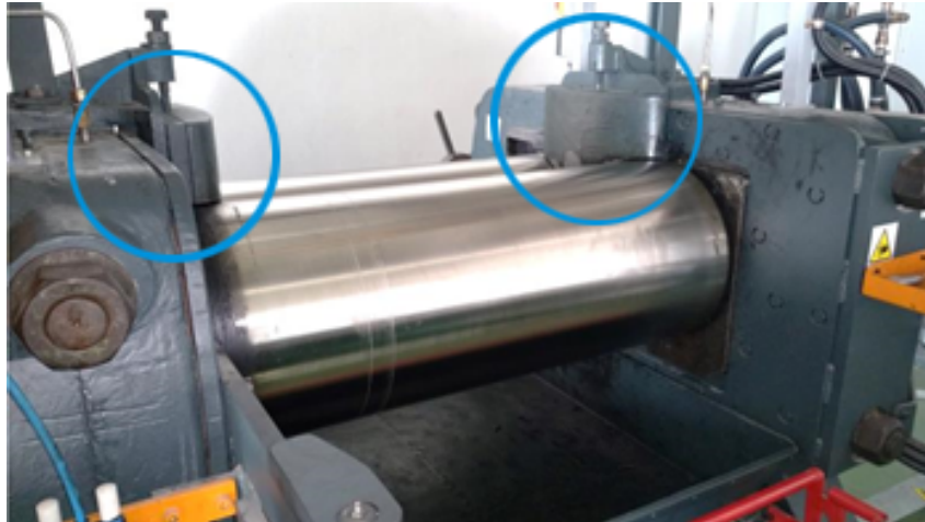
Obrázek 31 – Distanční elementy na reálném uspořádání kalandru
