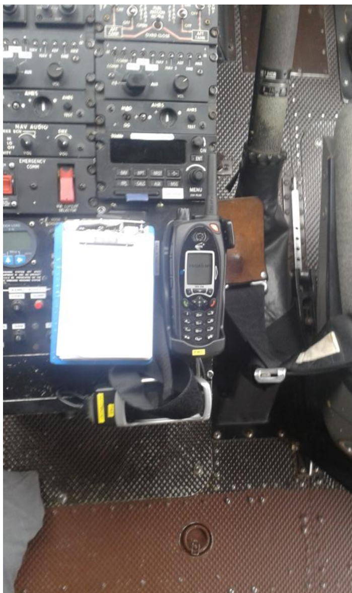
Obr. 13. Zástavba terminálu G3 ve vrtulníku PČR.
