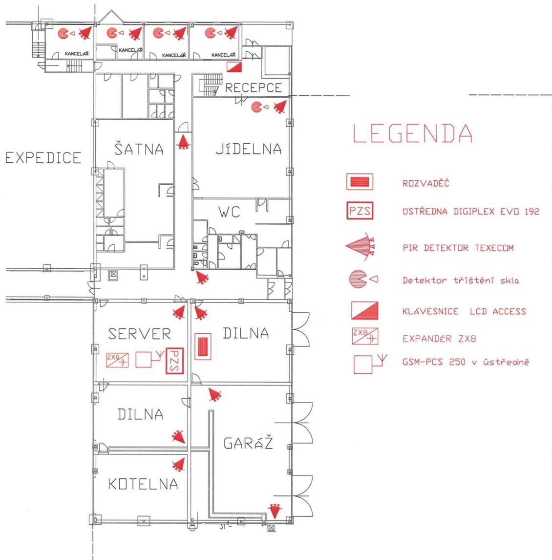
Obr. 24 - Umístění komponentů v přízemí v administrativní části [43]
