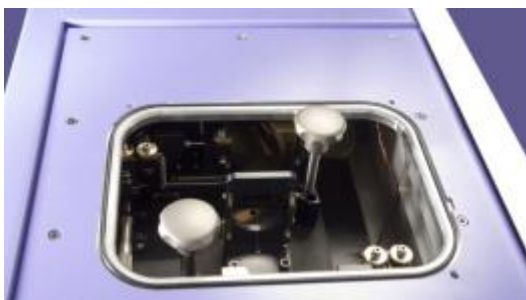
Obr. 19 Měřicí prostor u transmise v přístroji TPS spectra 3000 [4]
