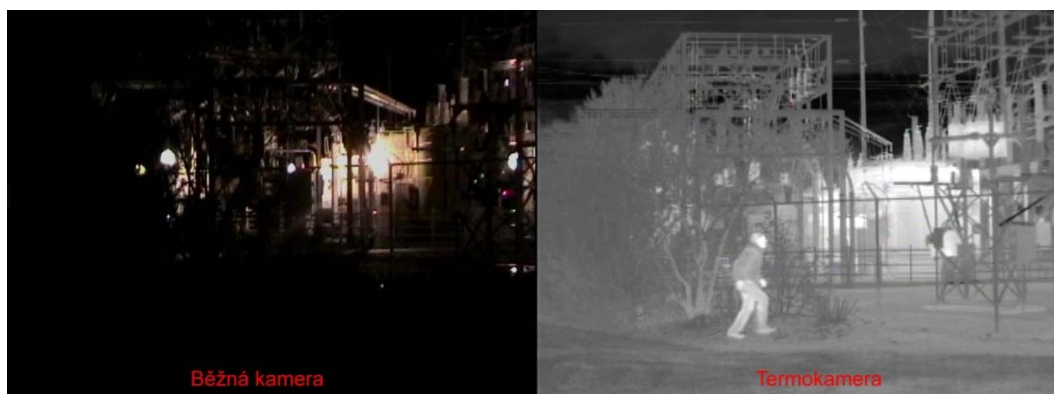
Obr. 42. Rozdíl mezi běžnou kamerou a termokamerou [42], upravil Svrčina, 2016
