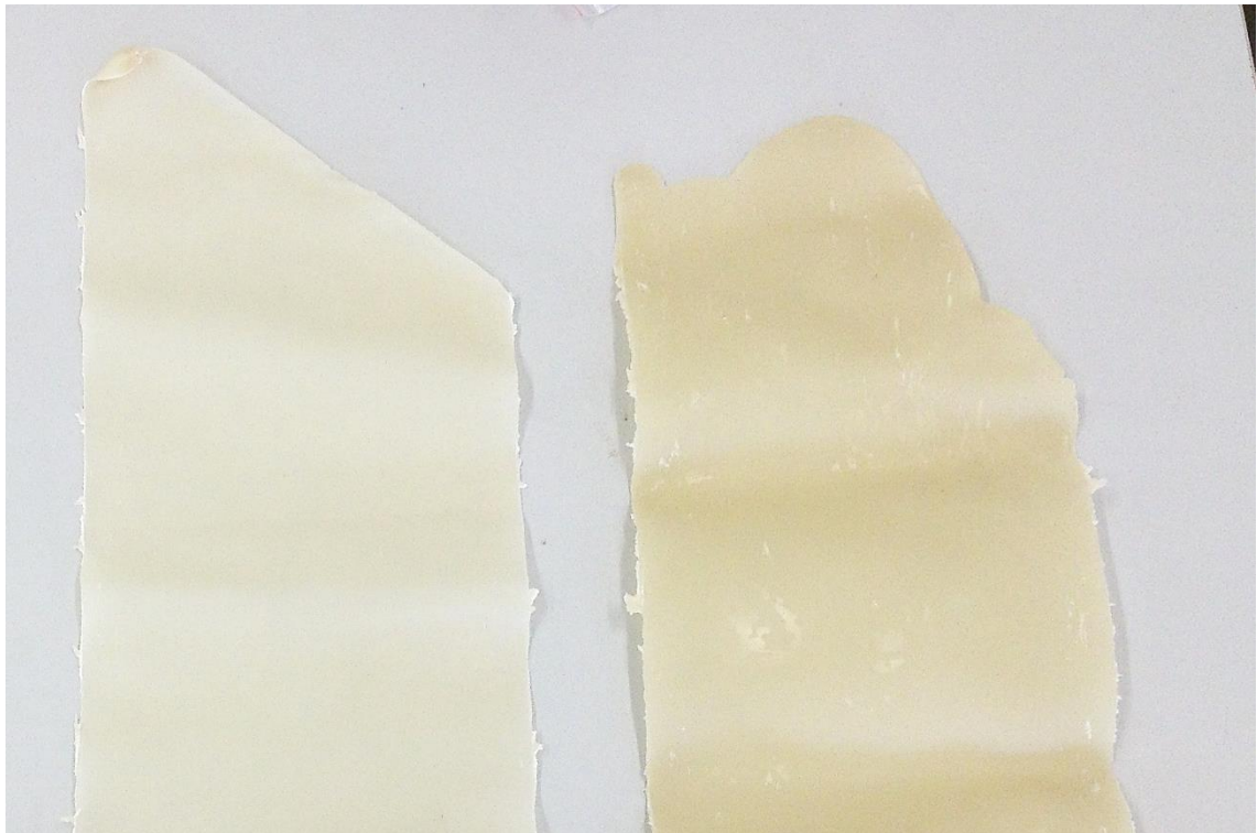
Obrázek 20. Folie ze směsi PVC/PVB 50:50 (vlevo) směsi PVC/rec. PVB 50:50 (vlevo).
