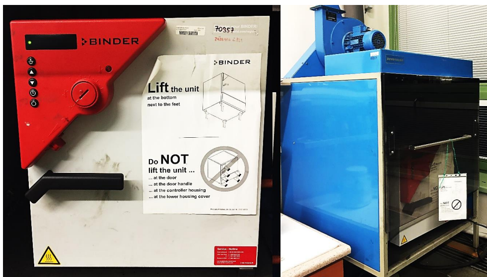
Obrázek 25. Sušárna využívaná pro tepelné namáhání polymerů.
