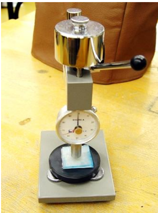
Obrázek 24. Fotografie tvrdoměru typu Shore A.
