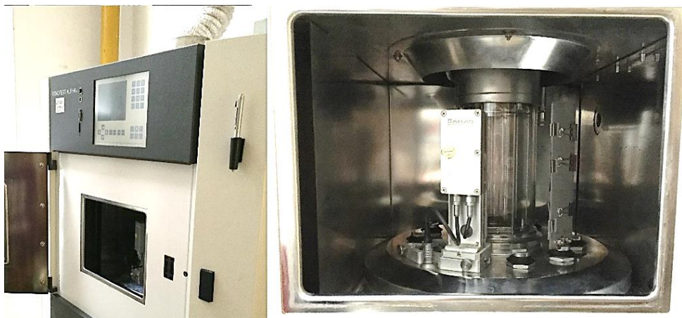
Obrázek 27. Zařízení Xenotest Alpha + (vlevo), komora přístroje s xenonovou lampou a umístěnými vzorky (vpravo).
