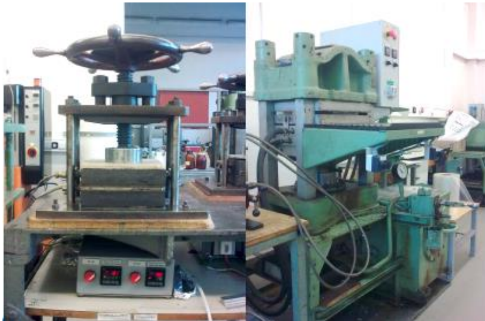
Obrázek 22. Mechanický lis (vlevo), hydraulický lis (vpravo).
