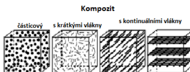
Obr. 4 Rozdělení kompozitních materiálů podle geometrického tvaru plniva. [23]
