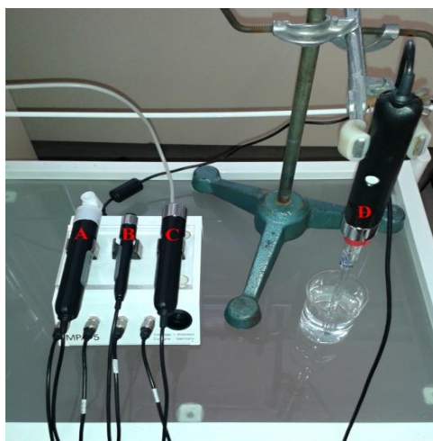
Obr. 11. MPA stanice se sondami: A – tewametr, B – korneometr, C – mexametr, D – pH metr [vlastní zdroj]
